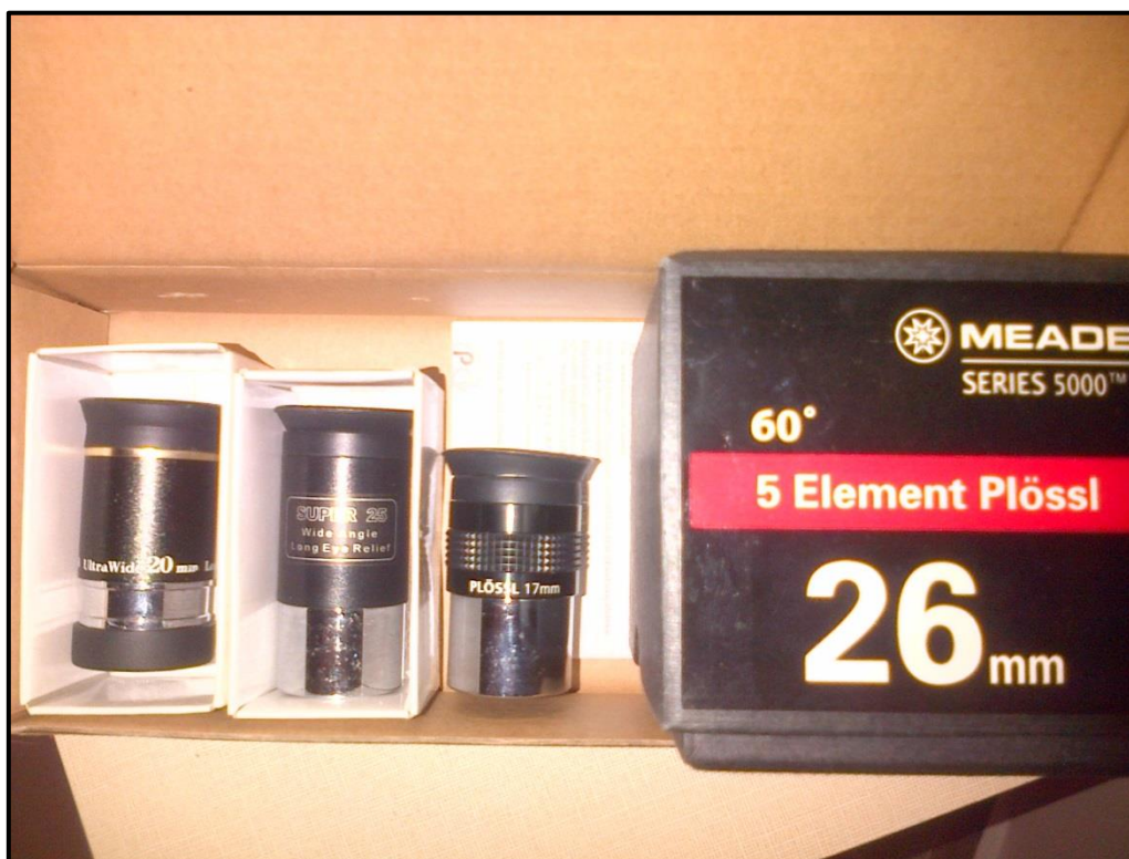
Obrázek 15: Některé z okulárů, které se používají při vizuálním pozorování. V čase, kdy se zrovna nepozoruje, bývají okuláry umístěné v uzamykatelné skříňce. Pro ochranu optických částí jsou uloženy v krabičkách, případně jsou zakryty ochrannými krytkami.
