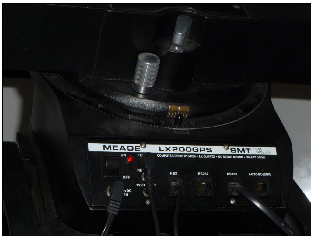
Obrázek 36: Detailnější pohled na panel dalekohledu. Tady má konektor rovněž ručka Autostar II (HBX).
