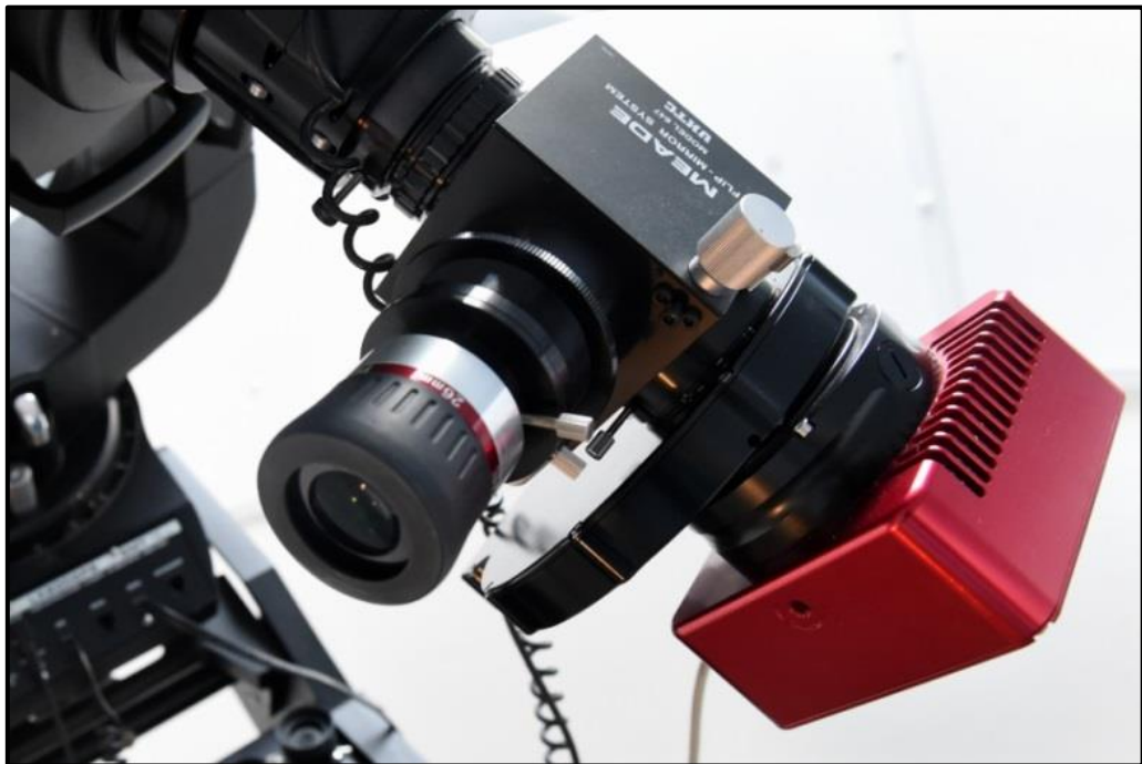
Obrázek 14: Detailní pohled na okulárový výtah. V pořadí od tubusu dalekohledu: zařízení na jemné ostření pomocí ručky, překlápěcí člen s okulárem, za ním je externí filtrové okolo s filtry a na konci červená CCD kamera (Fotka: S. Beerová).
