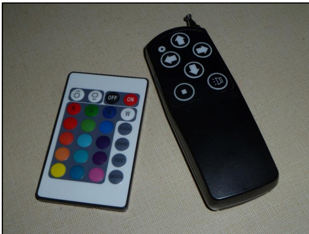
Obrázek 6: Dálkové ovládání osvětlení kopule, dálkové ovládání otevírání a zavírání štěrbiny kopule a otáčení kopule.
