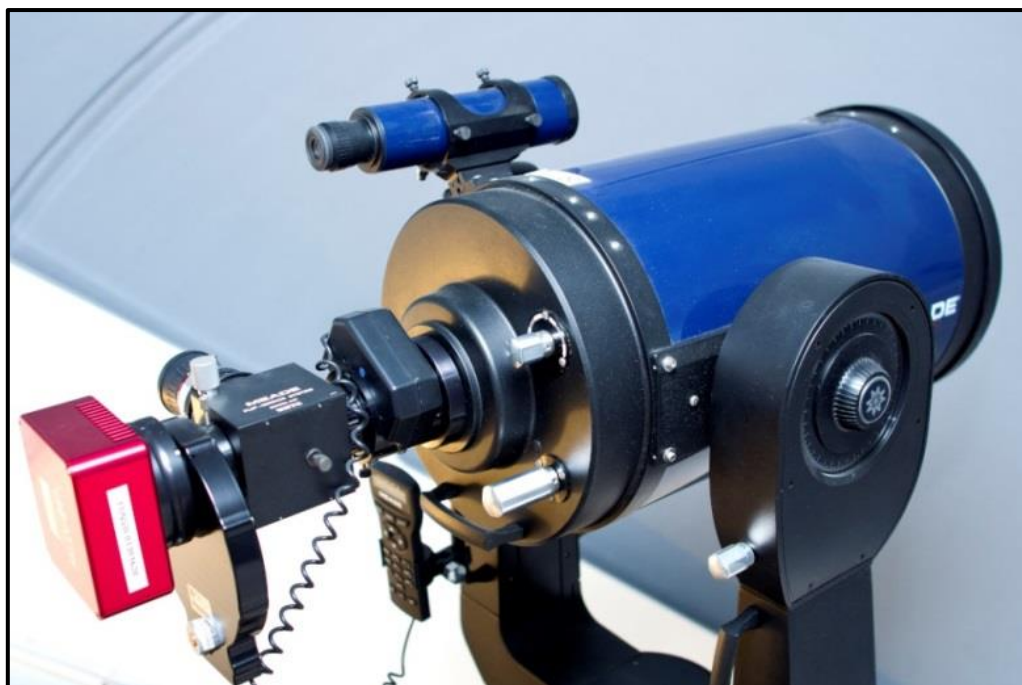
Obrázek 13: Dalekohled Meade LX200GPS s uchyceným hledáčkem a pozorovací technikou na okulárovém výtahu (Fotka: S. Beerová).
