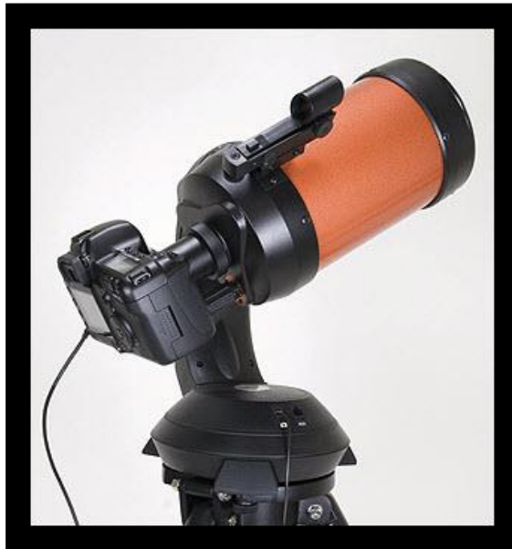
Obrázek 21: Fotoaparát umístěný v ohnisku dalekohledu 19
