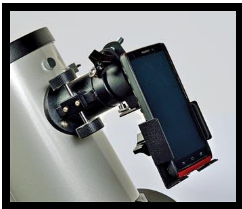
Obrázek 22: Metodu fotografování „za ohniskem“ je možné použít také pro fotoaparáty v mobilních telefonech 20
