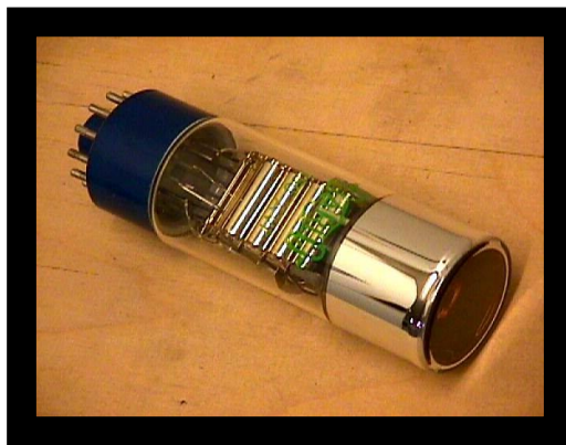
Obrázek 14: Technické řešení trubice fotonásobiče. 13
