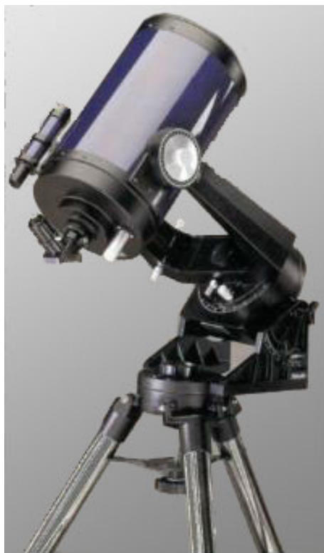
Obrázek 6.16: Vidlicová paralaktická montáž (řešená paralaktickým klínem), zdroj zde
