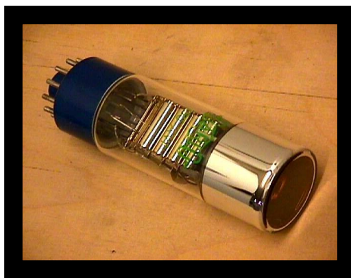
Obrázek 14: Technické řešení trubice fotonásobiče. 13
