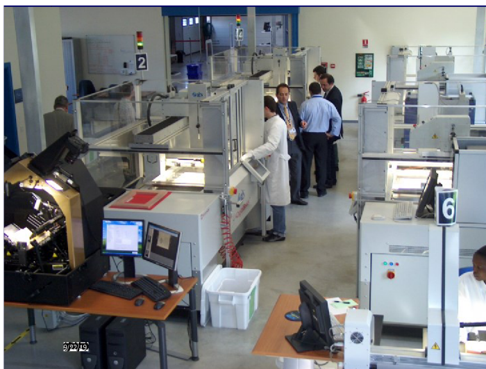
Obrázok 3 Pracoviško masovej priemyselnej digitalizácie s digitalizačnými robotmi
