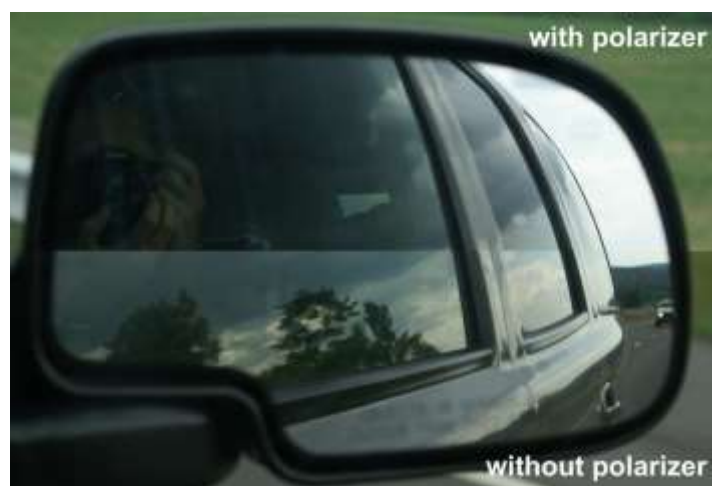
Obrázek 1-26: Obrázek rozdělen na dvě poloviny. Horní část obrázku s polarizačním filtrem, dolní polovina bez polarizačního filtru. Povšimněte si, že fotograf je přes sklo vidět, polarizace funguje díky blízkosti Brewsterova úhlu. Avšak zadní okýnka se již od Brewsterova úhlu vzdalují a na nich polarizační filtr nefunguje. (Autor Sbittante @ wiki, CC BY-SA 3.0)
