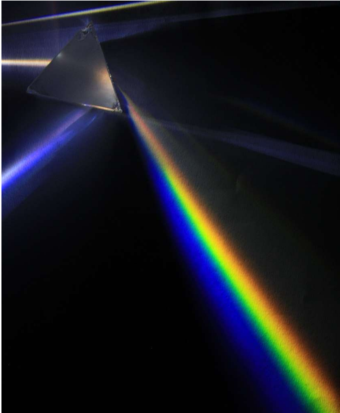
Obrázek 2-20: Rozklad světla na spektrum pomocí hranolu. Demonstrace disperze světla na hranolu. (Autor D-Kuru @ Wikimedia CC BY-SA 3.0)
