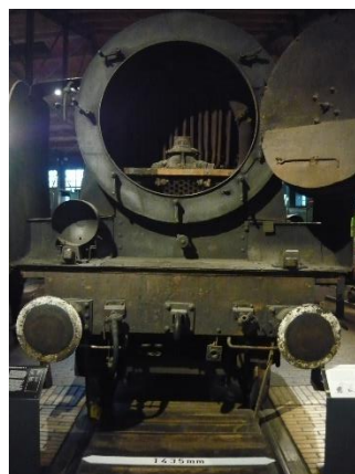
Kotel parní lokomotivy v depu
