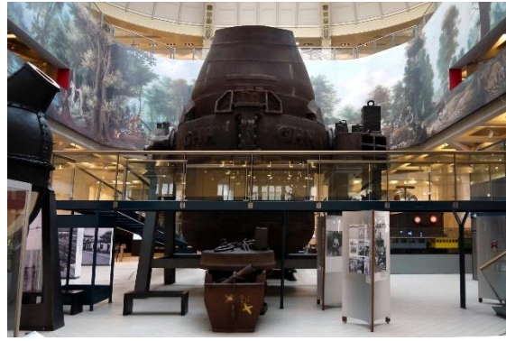
Hala s expozicí těžkého průmyslu – uprostřed LD kyslíkový konvertor, vlevo Bessemerův plávkový konvertor (foto J. Šíl, 2018)
