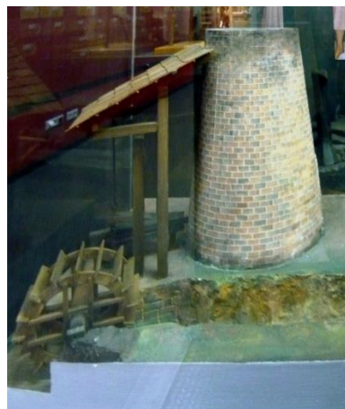
Model dýmačky s vodním kolem vhánějícím vzduch do pece v expozici Národního technického muzea v Praze
