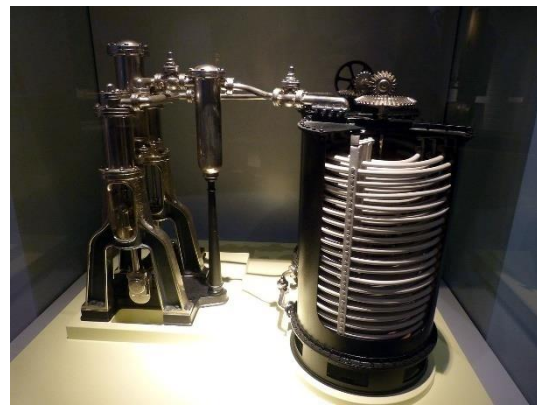
Model Lindeho kompresního chladicího stroje v Německém muzeu v Mnichově
