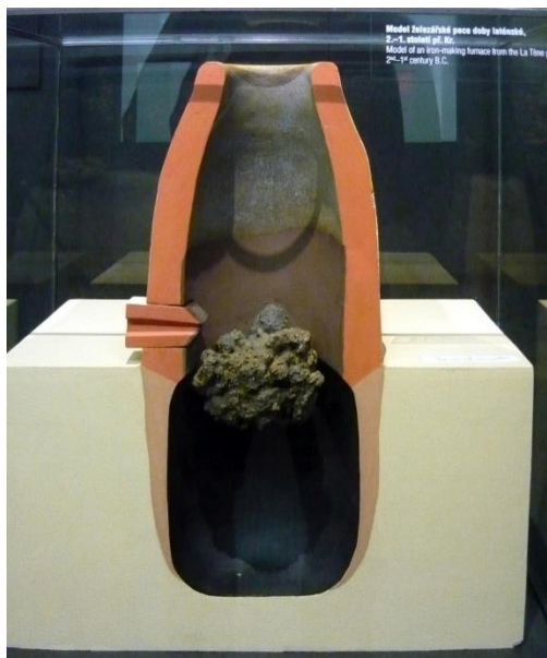
Model laténské železářské pece se zahlubnou nístějí v expozici Národního technického muzea v Praze
