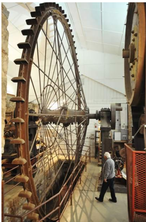
Kolo Peltonovy turbíny v elektrárně dolu Northstar v Grass Valley
