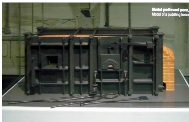
Model pudlovací pece v expozici železářství Národního technického muzea (foto J. Šíl, 2017)
