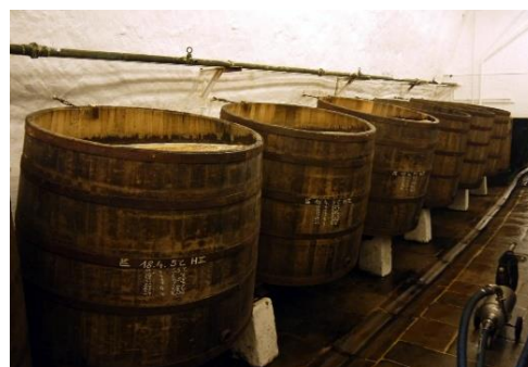
Spilka s dřevěnými kvasnými káděmi pro malovýrobu tradičními prostředky v pivovaru Prazdroj v Plzni (foto J. Šíl, 2019)
