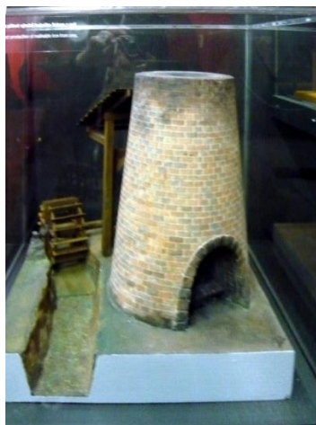
Model dýmačky s vodním kolem vhánějícím vzduch do pece v expozici Národního technického muzea v Praze
