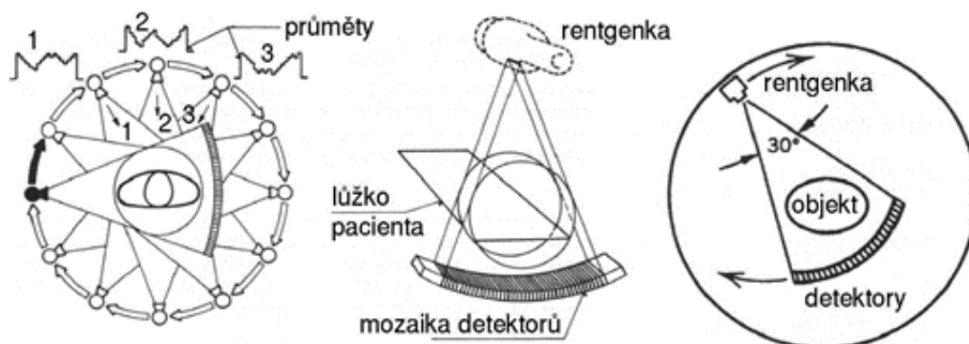
Obrázek 71 Třetí generace CT přístrojů je v současné době zřejmě nejpoužívanější. Mozaika detektorů leží naproti rentgenke na kruhovém oblouku o rozvoru zhruba 30^{\circ} – 45^{\circ} se středem v rentgenke. Lineární pohyb je vyloučen, různých průmětů se dosahuje pouze rotací rentgenky a systému detektorů okolo pacienta. Upraveno podle [22].
