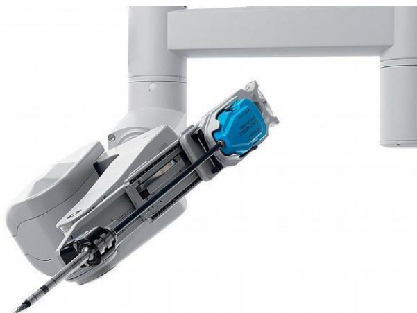
Obrázek 110 Detail ramena operační konzole (robota) s operačním nástrojem [52].
