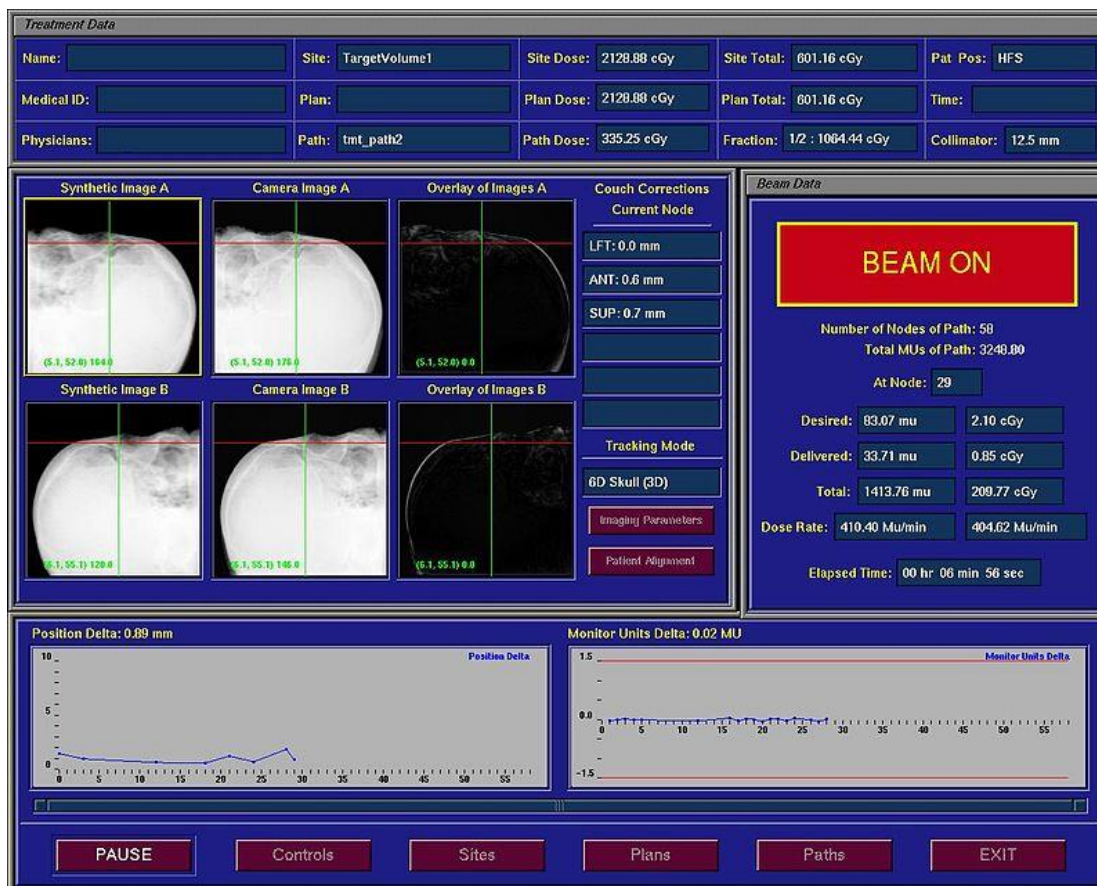
Obrázek 118 Screenshot z řídicího počítače CyberKnife (jméno ošetřujícího lékaře je odstraněno, stejně jako všechna jména, lékařské záznamy a data). Za povšimnutí stojí 6 zobrazení ve dvou řadách v levé části obrázku. Zobrazení označená „Synthetic Images“ jsou vytvořena počítačem, zatímco zobrazení označená „Camera Images“ jsou vytvořena X-kamerami, jež jsou součástí CyberKnife. Zbývající dvě zobrazení označená „Overlay“ jsou digitální rozdíly syntetických obrazů a kamerových obrazů. Odchylka mezi oběma typy zobrazení je označena jako delta [58].
