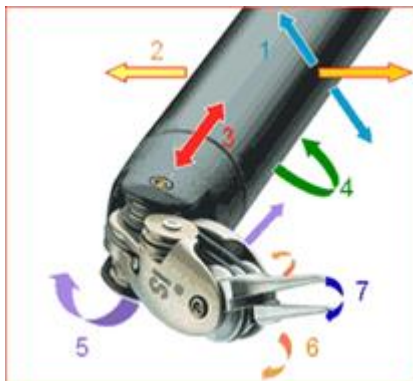
Obrázek 111 Stupně volnosti nástroje [53].
