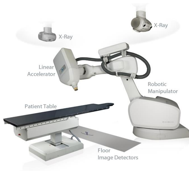
Obrázek 117 Hlavní komponenty CyberKnife® [Zdroj: https://www.multicare.org/ ].
