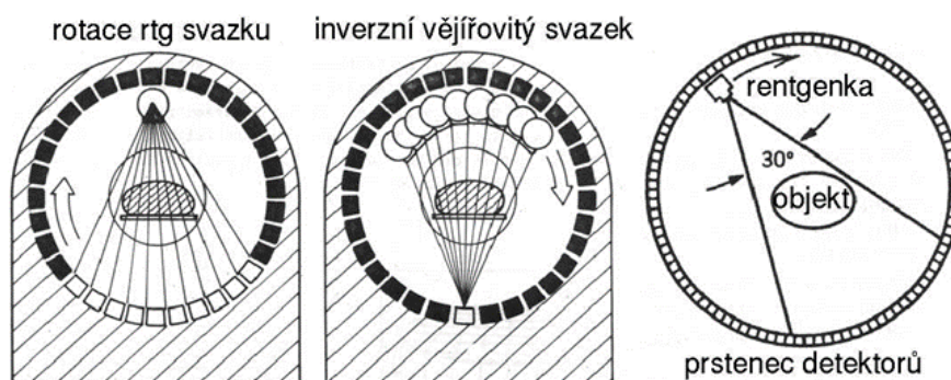
Obrázek 75 : Čtvrtá generace CT přístrojů má stabilní (nerotující) systém detektorů; rotuje pouze rentgenka a průměty se získávají z různých sektorů prstencového systému detektorů. Upraveno podle [22].
