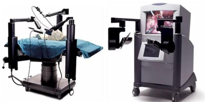
Obrázek 108 Robotický systém ZEUS – ramena a konzole [Zdroj: https://www.space.com ].
