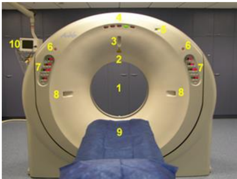
Obrázek 66 Toshiba Aquilion 16 – konstrukční prvky: (1) gantry \varnothing 720 mm; (2) mikrofon; (3) poziční laser (sagitální); (4) kontrolky; (5) indikace expozice rentgenového záření; (6) stop tlačítko; (7) kontrolní panel; (8) poziční laser; (9) pacientské lůžko; (10) EKG monitor.
