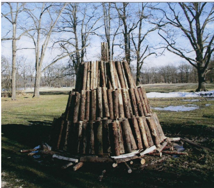
Experimentální pálení dřevěného uhlí v milíři v Ohradě u Hluboké nad Vltavou (Woitsch, 2007).
