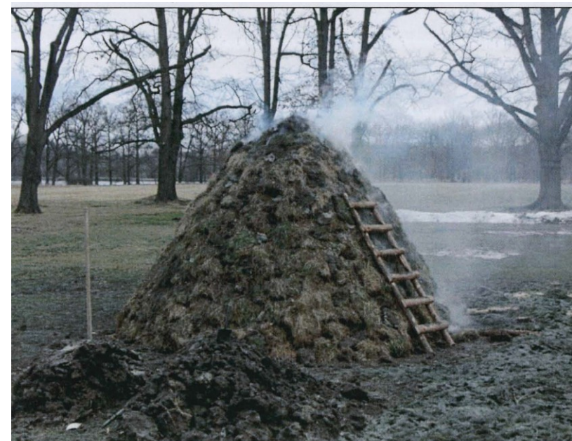
Experimentální pálení dřevěného uhlí v milíři v Ohradě u Hluboké nad Vltavou (Woitsch, 2007).
