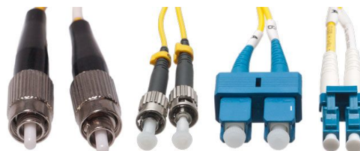
Obrázek 5.18: Koncovky pro optická vlákna, zleva FC, ST, SC a LC (vždy po dvojicích) 4
