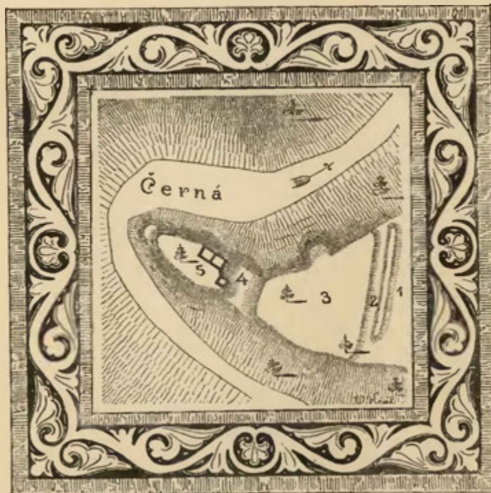
Plán hradu Sokolčí: 1. Plán lesní před náspem předhradským; 2. příkop; 3. předhradí; 4. příkop mezi předhradím a zadním hradem; 5. zadní hrad se zříceninami věže branné a paláce. (Měřitko 1 : 2880. Sever nahoře.)
