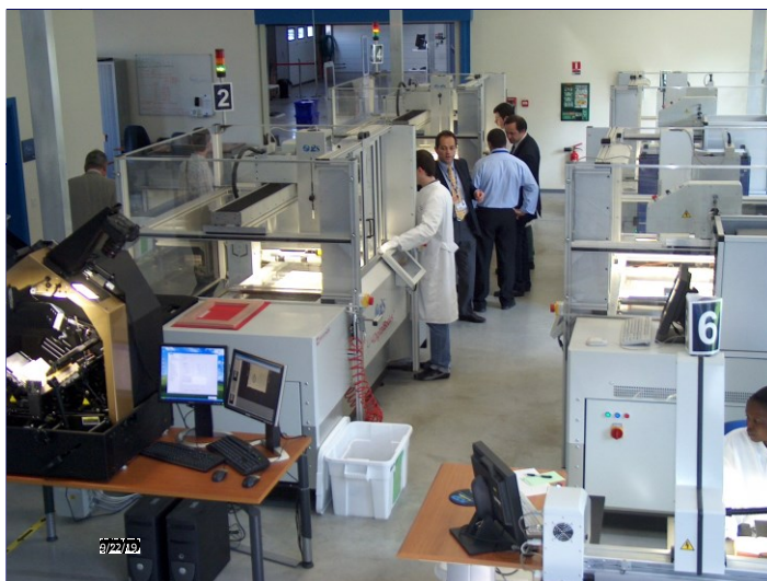
Obrázok 3 Pracovisko masovej priemyselnej digitalizácie s digitalizačnými robotmi
