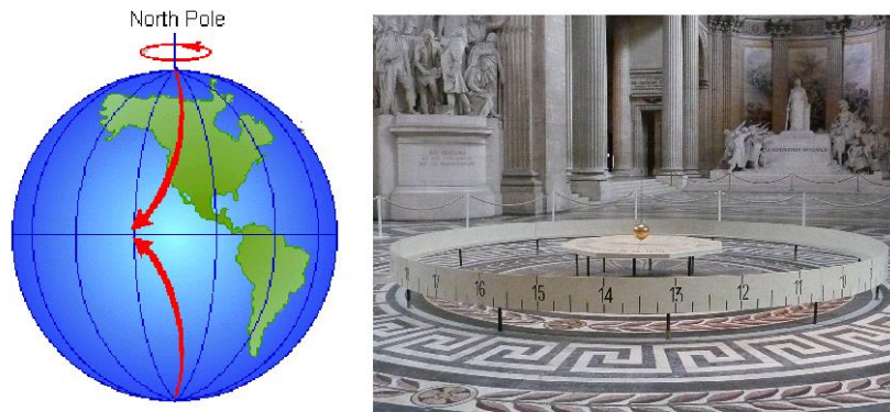
Obrázek 61: Vlevo je znázorněno stáčení trajektorií proudů na Zemi vlivem Coriolisovy síly [E24] a vpravo je Foucaultovo kyvadlo v Paříži [E25].
