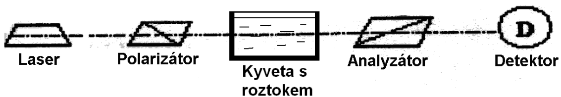
Obr. 2 – Experimentální uspořádání pro stanovení stáčivosti roztoku sacharózy
