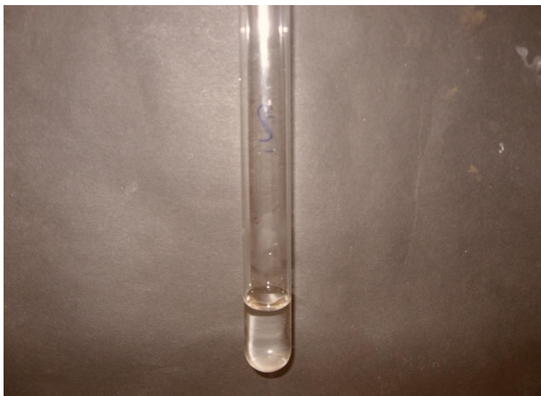
Obrázek 74. Zkumavka se vzorkem nepotvrzující přítomnost síranů v odebraném vzorku z pískovce (foto David Witoš 2019).
