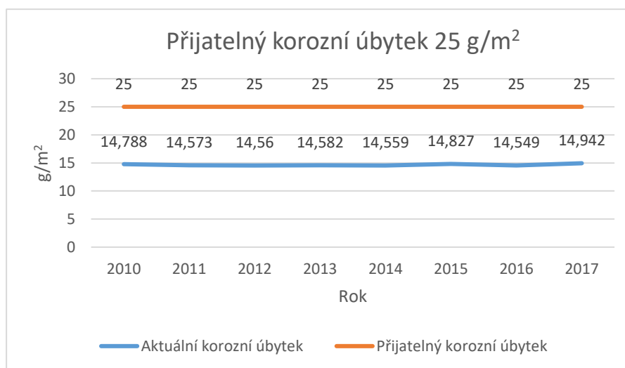
Obrázek 29. Aktuální a přijatelný korozní úbytek zinku v Opavě ( \text{g/m}^2 ).
