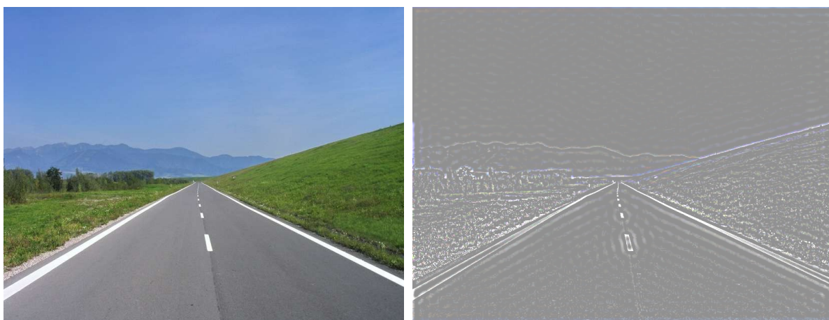
Obr. 31: Pásmový filtr pomocí FT a IFT
