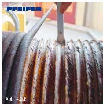
Abb. 4.2.E Reduzierter Rillendurchmesser auf Winde
