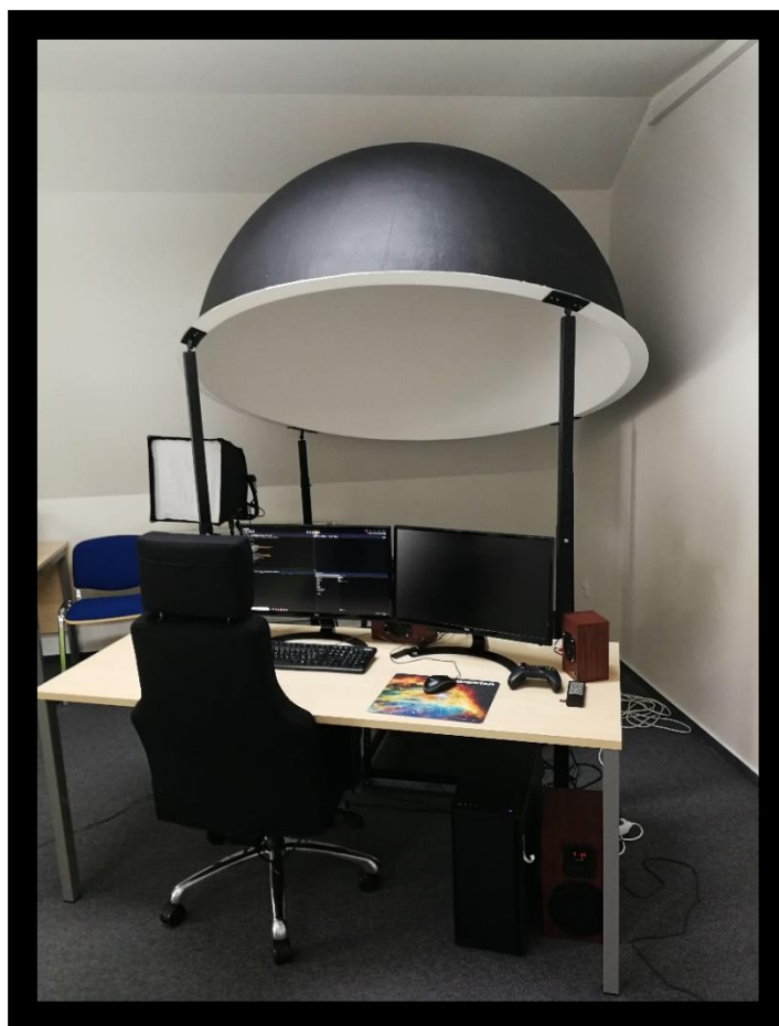
Obrázek 28: Projekční kopule v produkčním studiu Unisféry, projekce je realizována v prostředí Digistar 6 jedním dataprojektorem s objektivem typu „rybí oko“. 38
