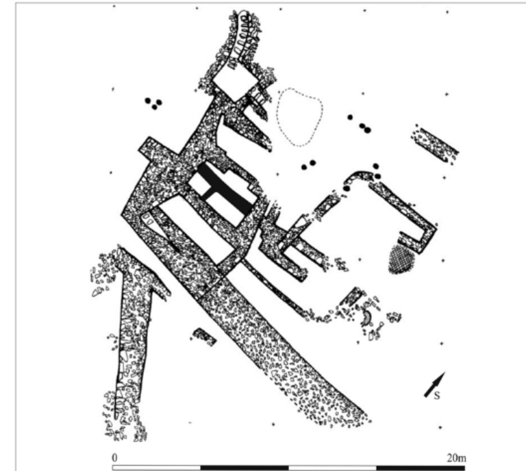
Obr. 2. Mstěnice, k. ú. Hrotovice, okr. Břeclav. Pozůstatky stavby zjištěné při záchranném archeologickém výzkumu v zaniklé vsi Mstěnice, interpretované jako vodní mlýn. Mlýnská budova v levé části plánu. Černé zdivo vyznačuje předpokládanou starší fázi
