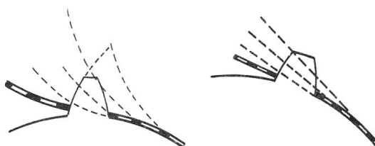
Obr. 40. Vyplnění perforačního otvoru filmu jističím čepem. Po stranách je váleček, jistič je ve svislém směru.
