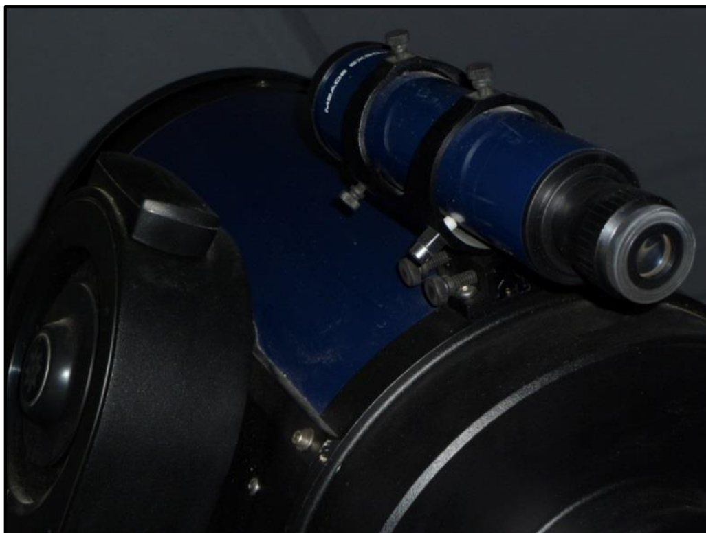
Obrázek 33: Hledáček – malý pomocný dalekohled, upevněný na tubusu.
