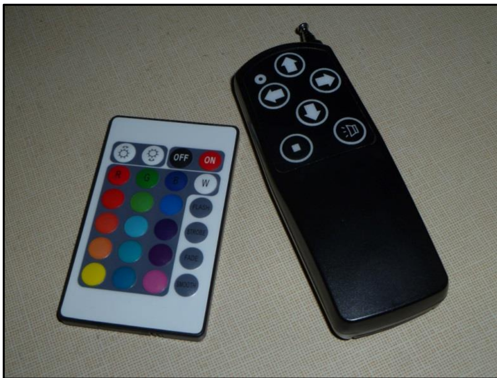
Obrázek 6: Dálkové ovládání osvětlení kopule, dálkové ovládání otevírání a zavírání štěrbin kopule a otáčení kopule.
