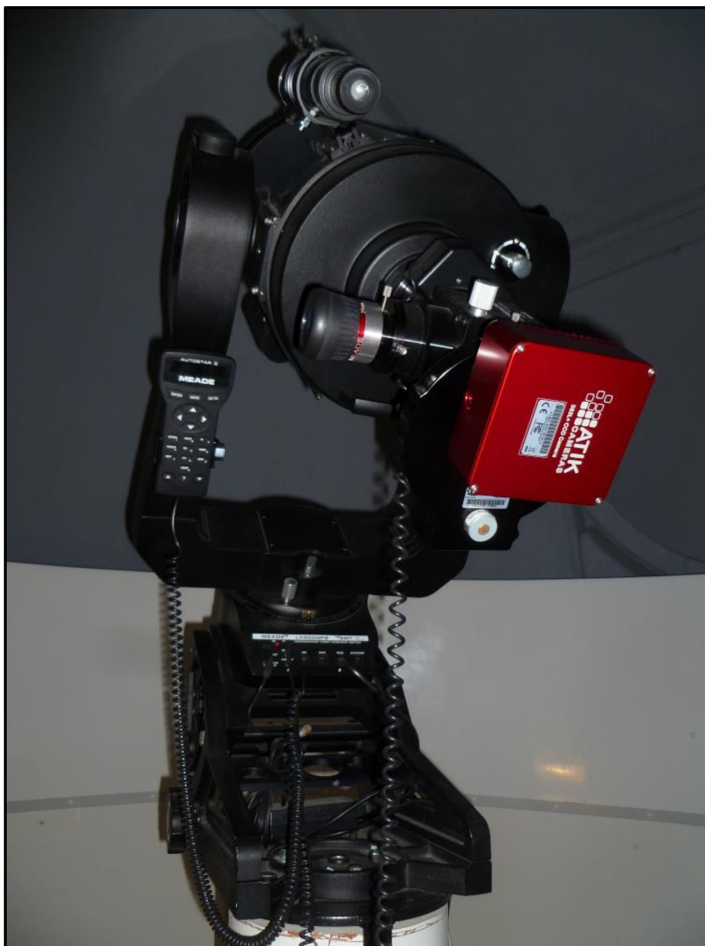
Obrázek 12: Pohled na celkovou sestavu dalekohledu. Je připevněný na pilíři, montáž je vidlicová na klínu. Umístění pilíře a montáže s dalekohledem je ve středu prostoru pozorovací kopule.
