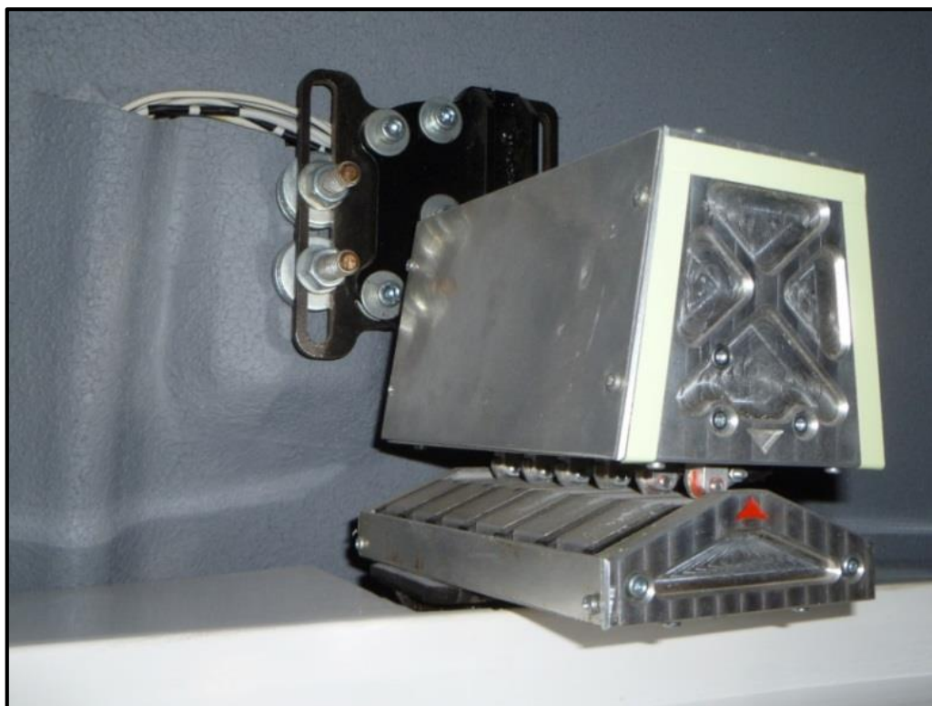
Obrázek 7: Nabíjecí kontakty. Jediná poloha kopule, při které jde otevírat či zavírat štěrbinu kopule.
