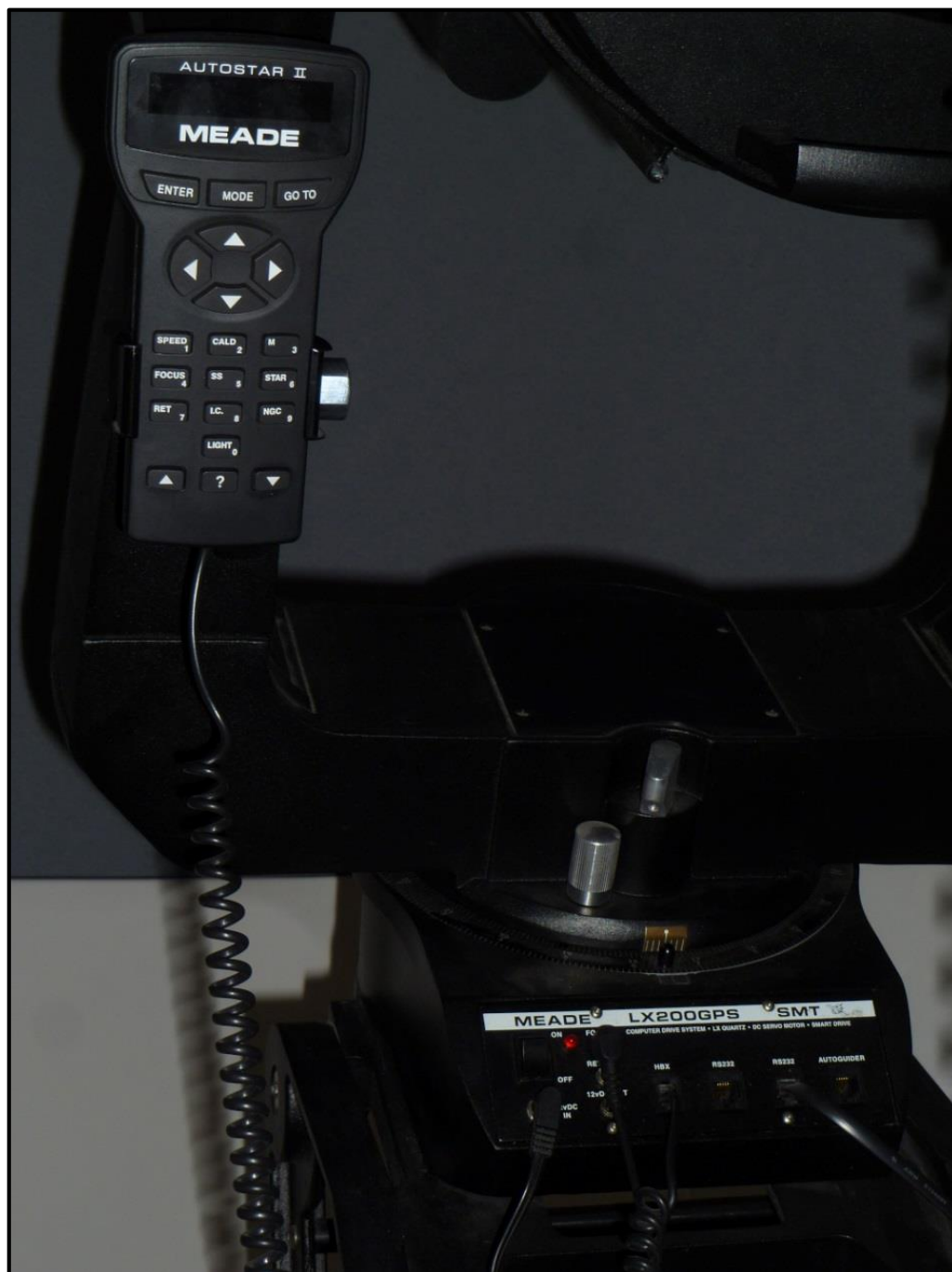
Obrázek 34: Ovládací ručka Autostar II s tlačítky. Je uchycená k montáži dalekohledu, lze ji vzít do ruky vysunutím z držadla.
