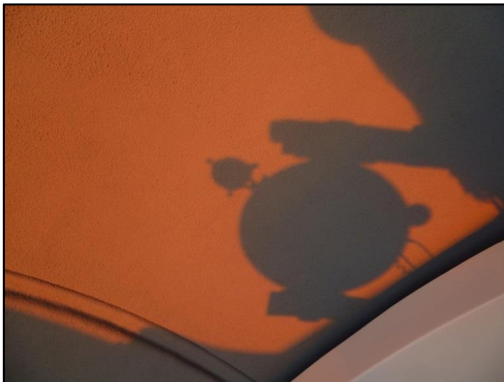
Obrázek 24: Míření pomocí stínu, zde na ploše kopule. Stín tubusu dalekohledu by měl být co nejmenší a nejkulatější. Řídit se dá i podle stínu hledáčku a závaží.
