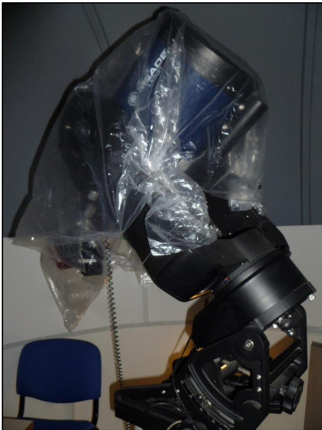
Obrázek 17: Dalekohled zakrytý obalem. Rovněž CCD kamera a další části okulárového výtahu jsou zakryty.
