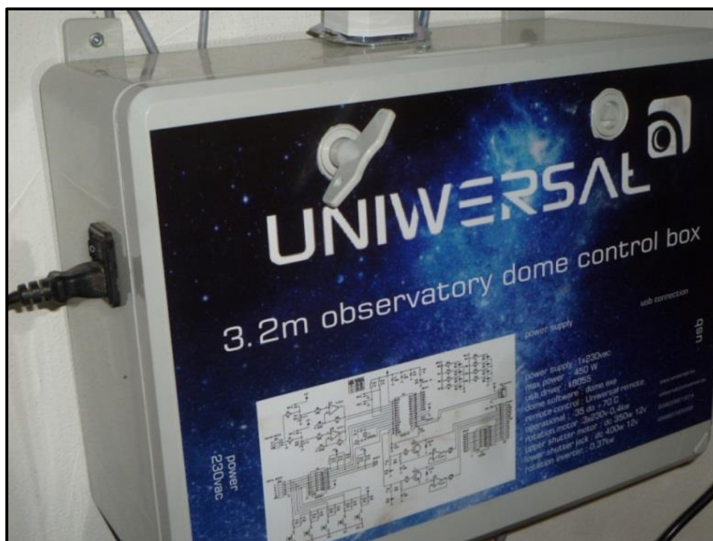
Obrázek 8: Ovládací skříňka otevírání a zavírání štěrbinu kopule a otáčení kopule. Na boku skříňky je tlačítko zapínání/vypínání.
