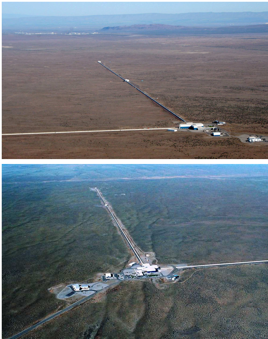
Obr. 8. Čtyřkilometrový americký interferometr LIGO v Hanfordu (stát Washington, USA). Zdroj: Caltech/MIT/LIGO Laboratory.
