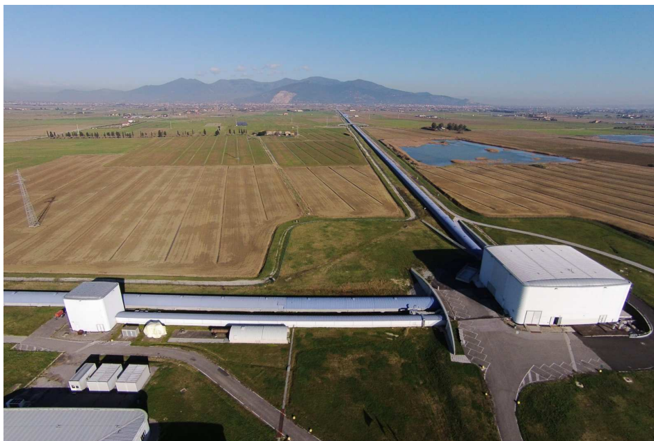
Obr. 10. Pohled na centrální stanici a jedno ze tříkilometrových ramen evropského detektoru gravitačních vln Virgo poblíž italské Pisy. Zdroj: Virgo Collaboration.
