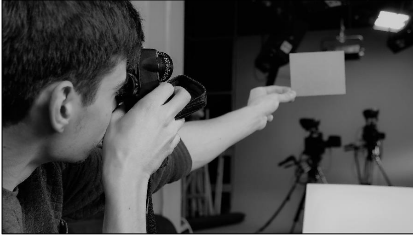
Obrázok 1: spotmeter využívame na meranie osvetlenia referenčnej plochy v presne vymedzenom uhle a smere. Vieme ním merať napríklad svetelný pomer na scéne.
