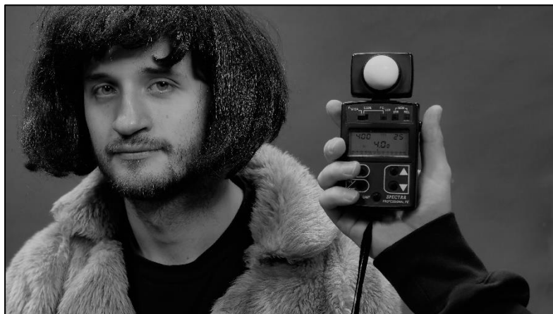
Obrázok 2: dopadajúce svetlo na objekt meriame luxmetrom. Meriame ním správnu svetelnú hladinu na scéne a zväčša hodnotu clony z luxmetru nastavujeme na kamere
