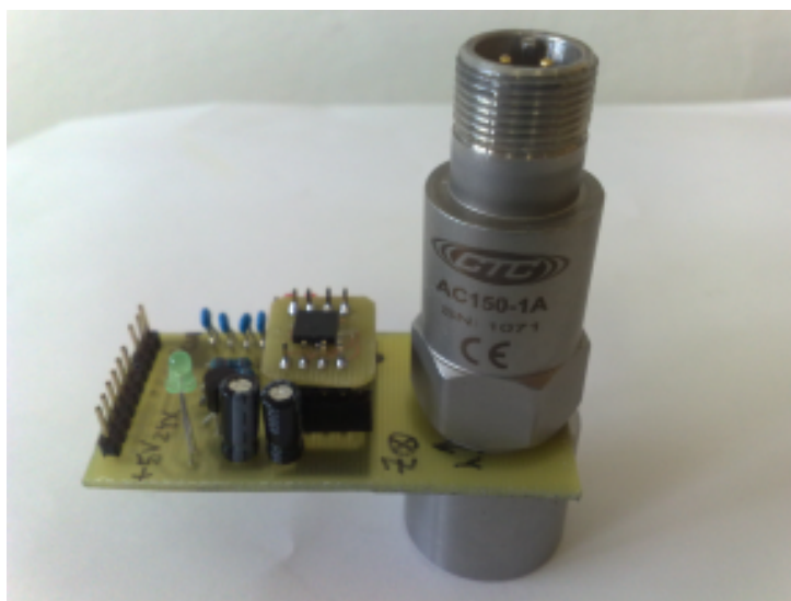
Obr. 20 Uchycení obou akcelerometrů na magnet.
