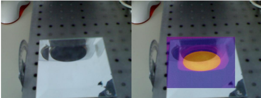
Obr. 4.13: Viditelný obraz, proložení viditelného a tepelného obrazu při 45° odrazu na skle
