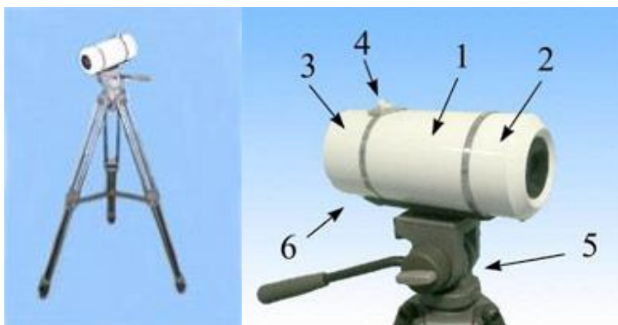
Obr. 93. Kamera SVIT na stojanu (vlevo) a náhled termokamery. 1 - sekce kryostatu s chlazenou ohniskovou maticí, 2 - odnímatelný objektiv a kalibrační jednotka, 3 - odnímatelná elektronika, 4 - hrdlo na naplnění tekutého dusíku, 5 - stojan kamery, 6 - připojovací oblast- standardní vysokorychlostní kabel USB 2.0 A/B, kabel (DUB-C5AB).
