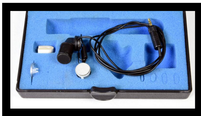
Obrázek 38: Souprava klopového mikrofону Sennheiser MKE 40 bez napájení a bezdrátového modulu. 51
