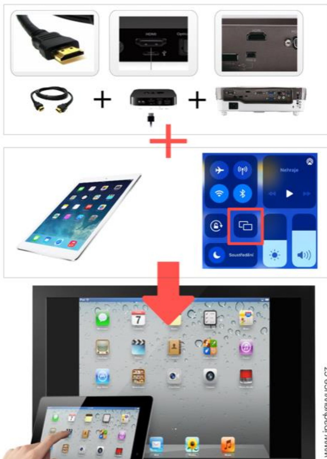
Obrázek 73: Schéma zapojení Apple TV bez redukce
