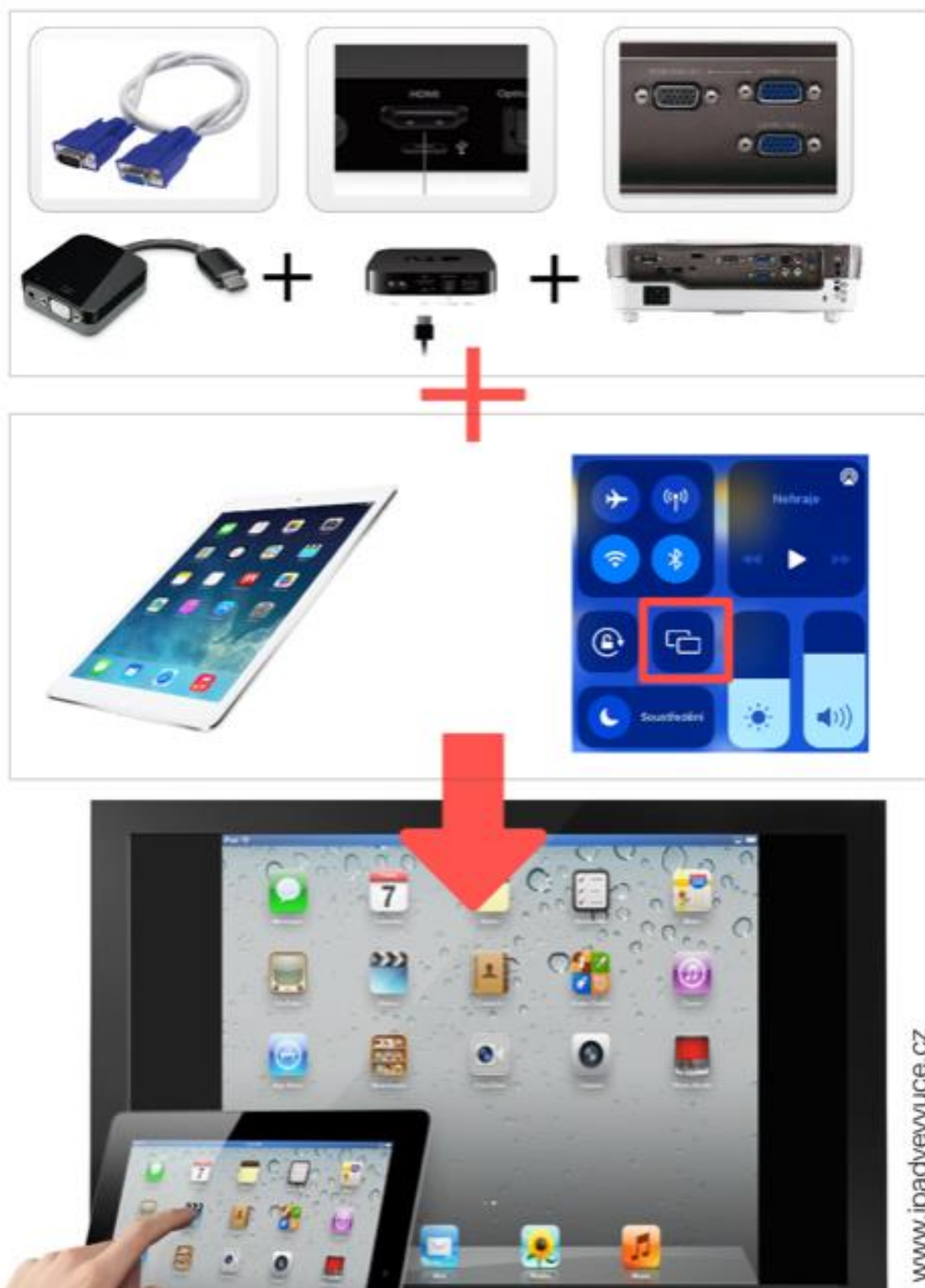
Obrázek 72: Schéma zapojení Apple TV s redukcí
