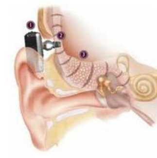
Ilustrační foto systému BAHA : 1 zevní zvukový procesor – odnímatelný, 2- titanový šroub implantovaný do kosti, 3-kostní vedení zvuku
