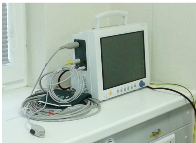
Obrázek 81: Monitor pro měření fyziologických funkcí (TK, TT, pulz, saturace O 2 , srdeční křivka)
