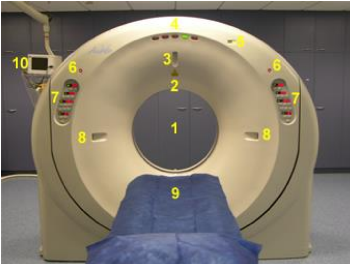
1. gantry \varnothing 720 mm 2. mikrofon 3. poziční laser (sagitální) 4. kontrolky 5. indikace expozice X-Ray 6. stop tlačítko 7. kontrolní panel 8. poziční laser 9. patientské lůžko 10. EKG monitor
