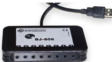
Obr. 24 Adaptér BJ-806 možností připojit a naprogramovat až 8 spínačů Zdroj: BJlive!, 2018
