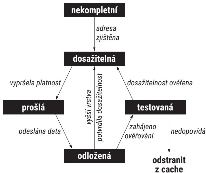
Obrázek 5.4: Změny stavu položky v cache sousedů
