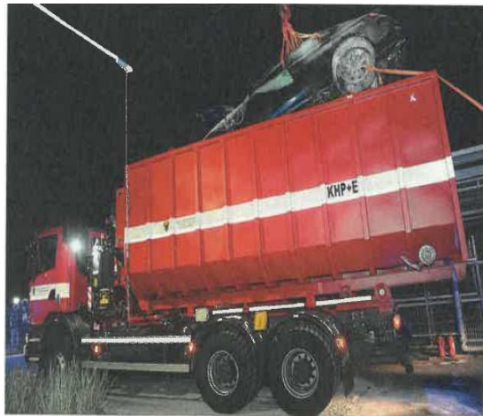
První případ použití dohašovacího kontejneru v ČR byl v roce 2020, kdy jej hasiči použili u hybridního BMW 330e, u kterého byla obava z opětovného rozhoření. Tehdy ještě byl naplněný celý vodou – dnes se již napouští jen k úrovni baterie.
