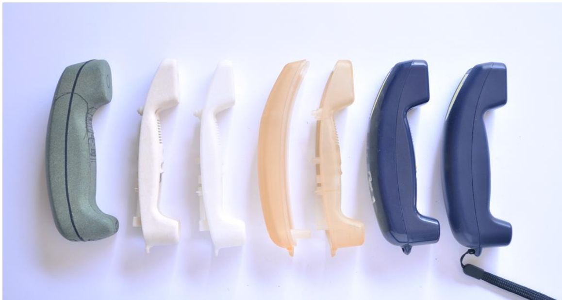
Obrázek 9 Příklad vývoje prototypů od prvotního návrhu z pěny po plast
