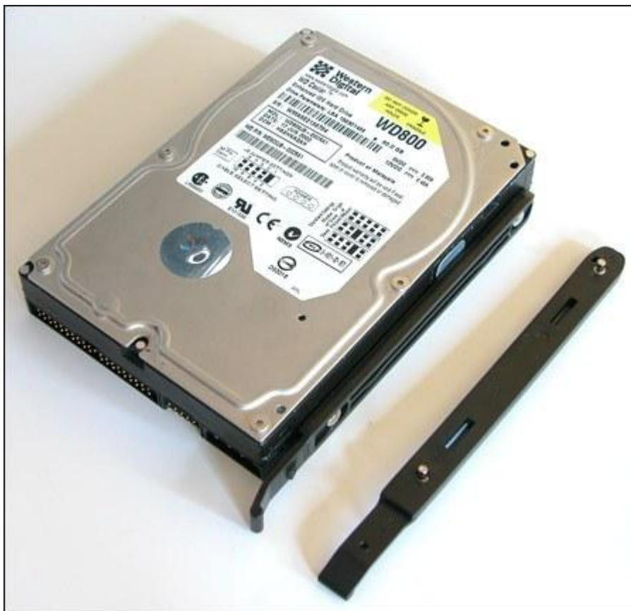
Obrázek 317 – uchycení disku pomocí plastových nástavců
