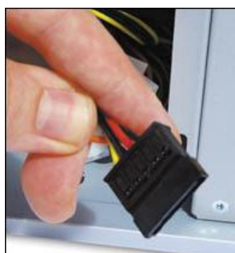
Obrázek 194 – vlevo datový kabel SATA, vpravo napájecí kabel pro zařízení SATA
