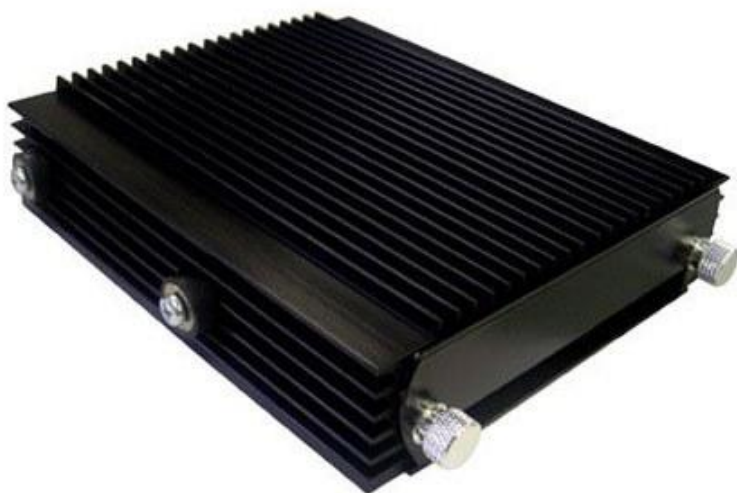
Obrázek 324 – odhlučňující disk Silencer do 5,25" šachty s pasivním chlazením
