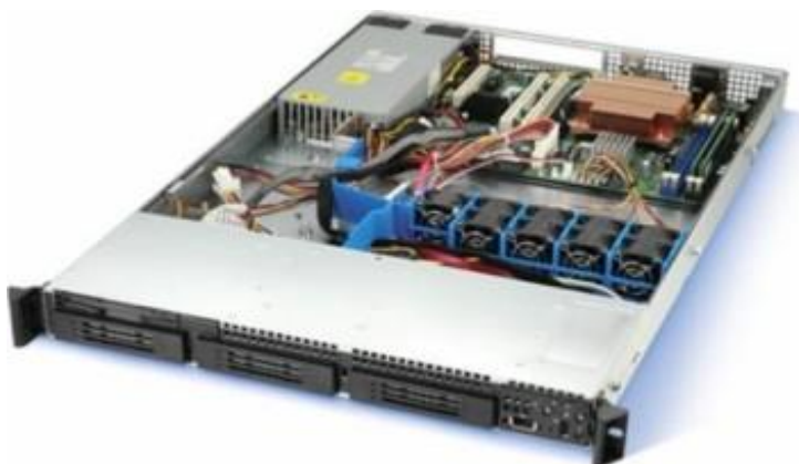
Obrázek 70 – vnitřní konstrukce rackového serveru
