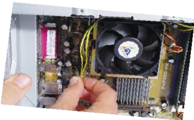
Obrázek 188 - Pokud to deska vyžaduje, zapojte i přídavné 12 V napájení
