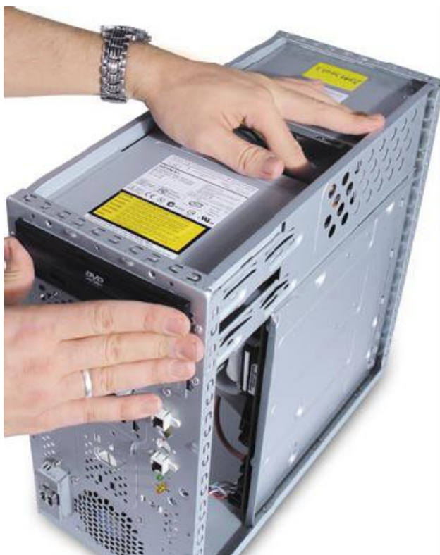
Obrázek 196 - Mechaniky pro 5,25" pozice zasunujte z vnější strany
