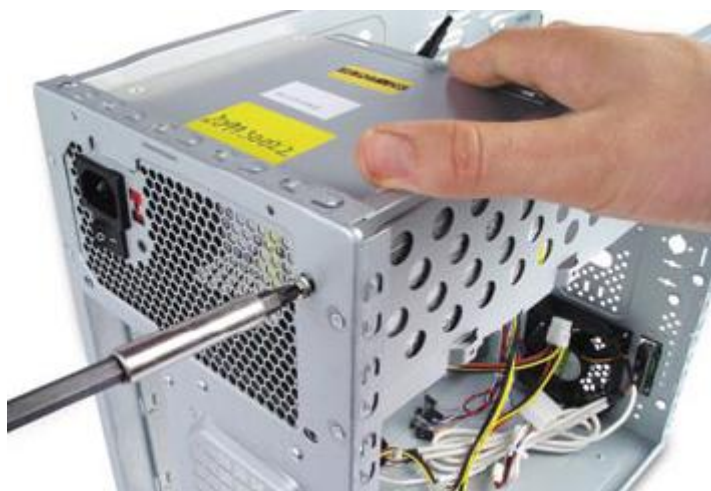
Obrázek 172 - Jako první namontujte zdroj. Pokud zdroj přichytíte nedostatečně, nejspíše se dočkáte nepříjemných vibrací
