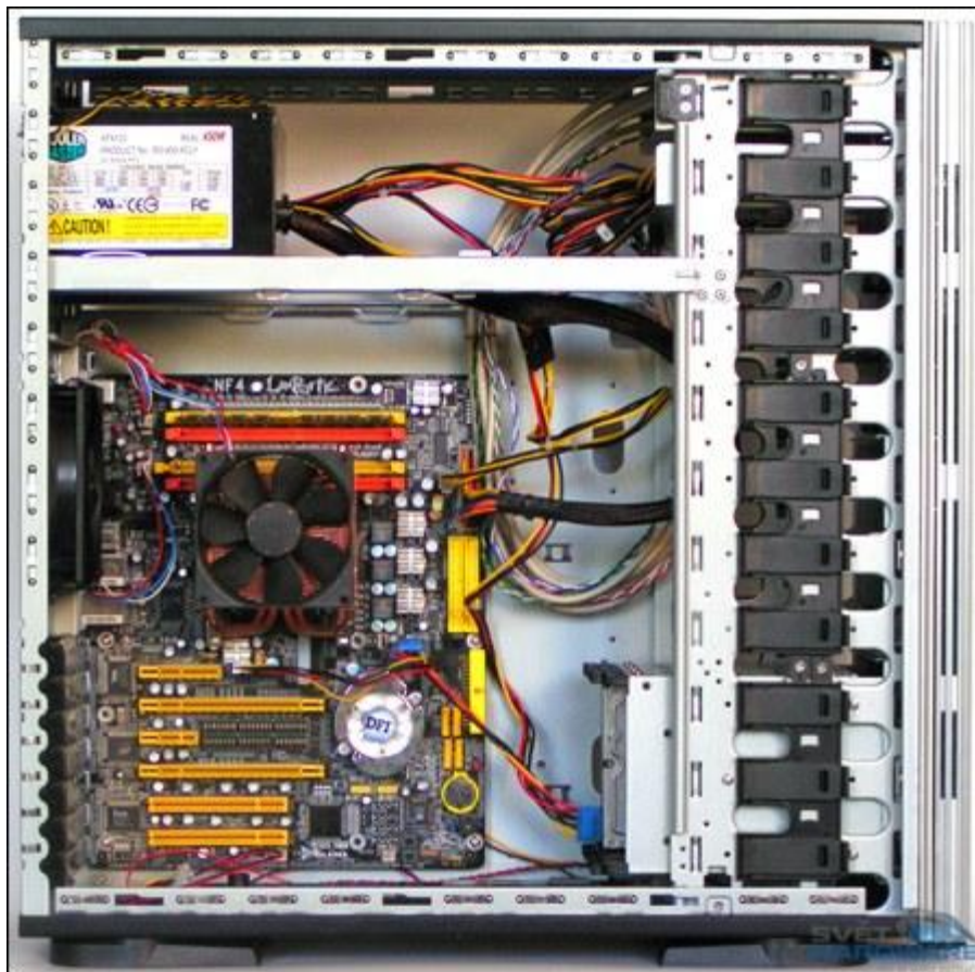
Obrázek 313 – vhodné rozmístění komponentů uvnitř skříně
