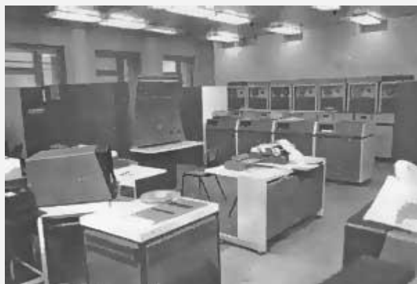
Obrázek 58 - EC1050: velký počítač pro rozsáhlé vědeckotechnické a ekonomické úlohy, osazený vícevrstevnými emitorově vázanými obvody ECL s výkonem 500 000 operací/s
