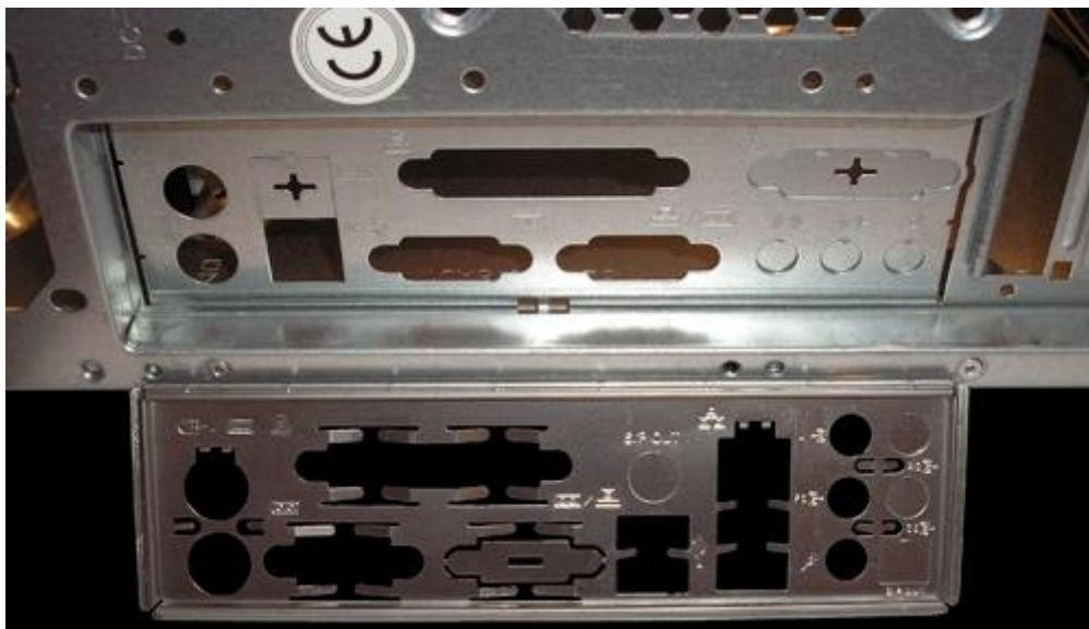
Obrázek 141 - osazení vložky kryjící komunikační konektory základní desky
