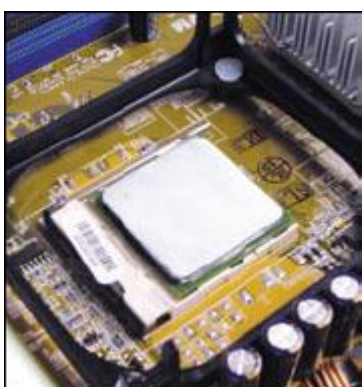
Obrázek 177 - Pastu rovnoměrně rozetřete do velmi tenké vrstvy pokrývající pouze kovovou plošku procesoru
