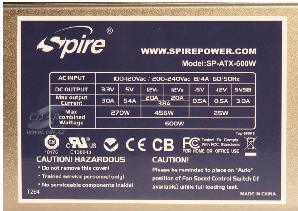
Obrázek 355 – štítek s údaji o parametrech zdroje
