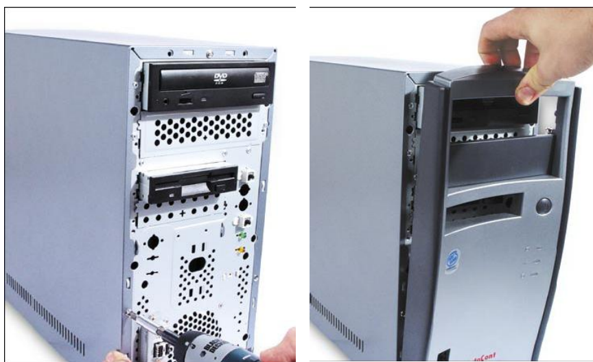
Obrázek 202 – sešroubování skříně a nasazení předního krytu
