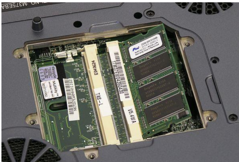
Obrázek 76 - Dva sloty SO-DIMM pro paměti DDR333. Na obrázku modul DDR 512MB.
