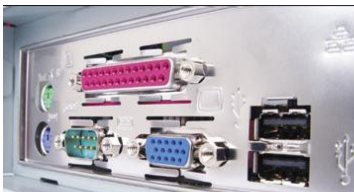
Obrázek 185 - Konektory musí přesně zapadnout do panelu, který jste předtím zevnitř uchytili do skříně
