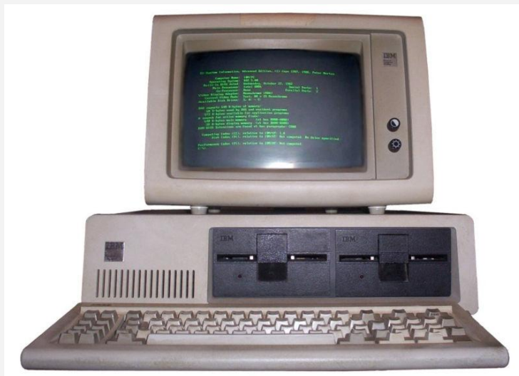
Obrázek 127 - IBM PC (IBM 5150) se zeleným monochromatickým monitorem (IBM 5151) a operačním systémem MS-DOS 5.0
