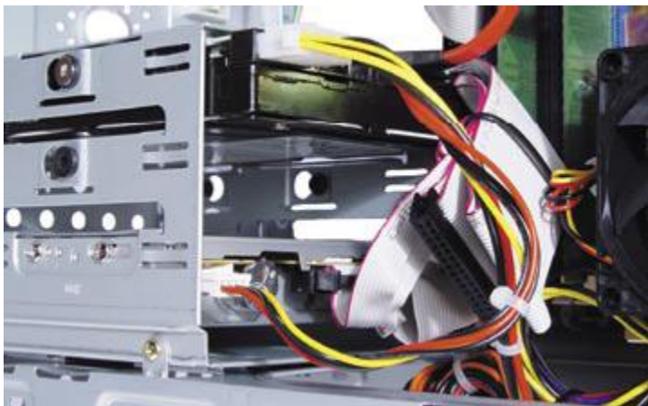
Obrázek 195 - zapojený disk a disketová jednotka
