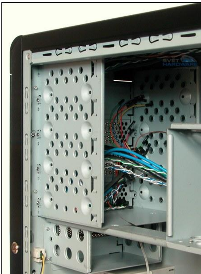
Obrázek 312 - kvalitně zaoblené hrany skříně z 0,8mm SECC
