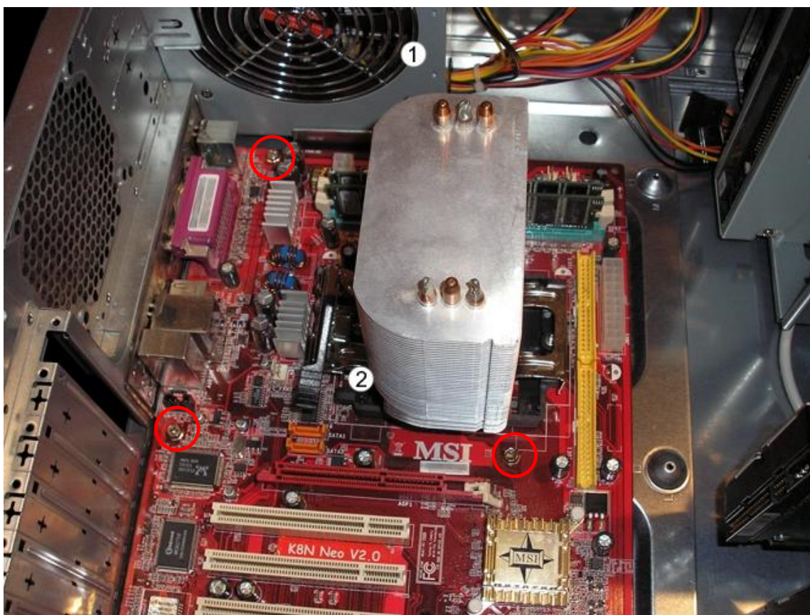
Obrázek 138 - osazení základní desky do počítačové skříně
