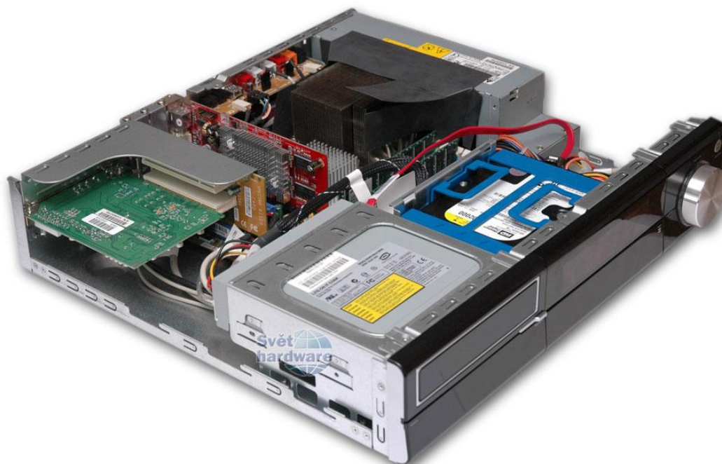
Obrázek 88 – vnitřní uspořádání Barbone FIC
