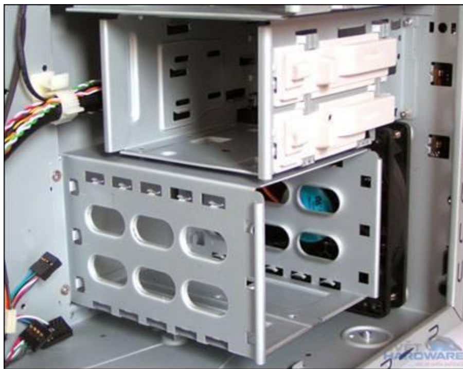
Obrázek 315 – jiný systém umístění disků pomocí plastových úchytů
