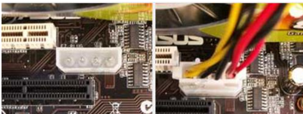
Obrázek 351 – použití molex konektoru pro napájení procesoru
