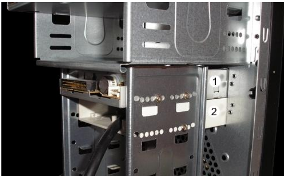
Obrázek 149 – umístění disketové mechaniky v šachtici, pohled na stranu konektorů
