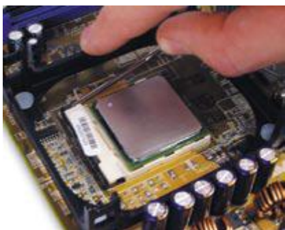
Obrázek 175 - Páčka mírně posune jednu z dírkovaných desek, a tím upevní procesor v patici
