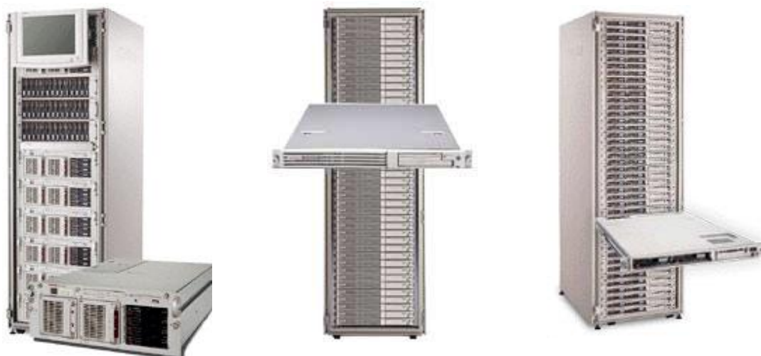
Obrázek 69 – příklad umístění zařízení do rackové skříně
