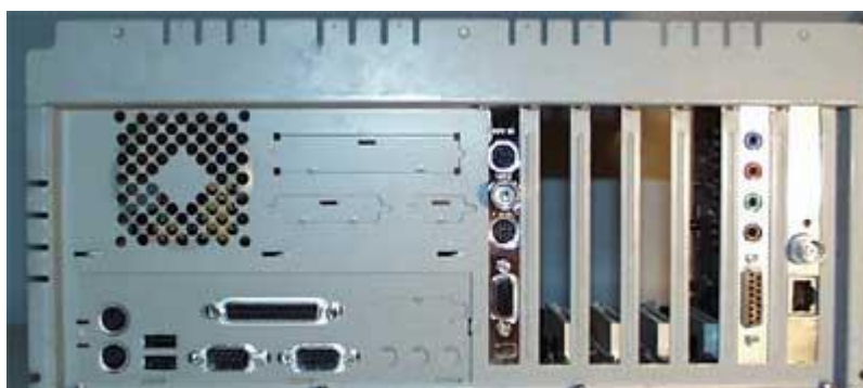
Obrázek 290 – zadní stěna Bigtower ATX s integrovanými konektory základní desky
