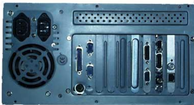
Obrázek 291 – uspořádání konektorů na zadní stěně skříně typu AT
