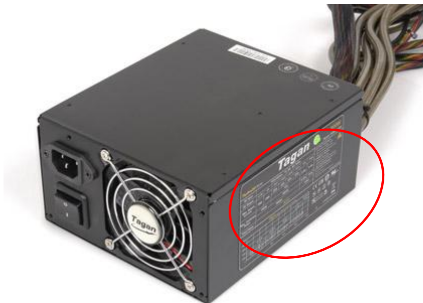
Obrázek 354 – na štítku zdroje můžete zjistit parametry
