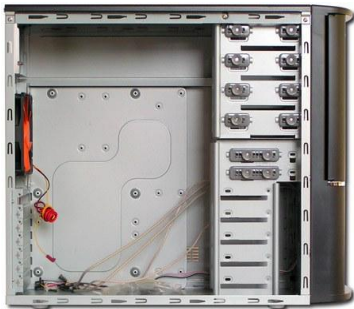
Obrázek 309 - typický middletower vyrobený z SECC
