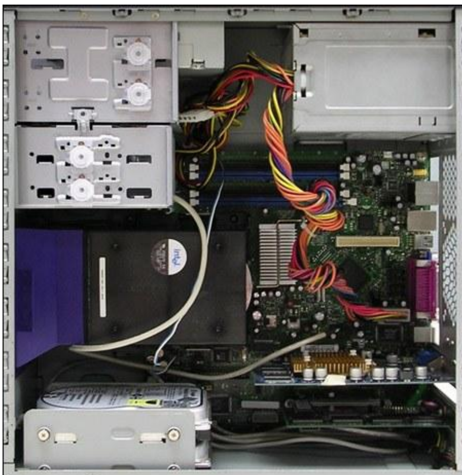
Obrázek 304 - koncepce BTX s tunelem na chladiči procesoru - minitower
