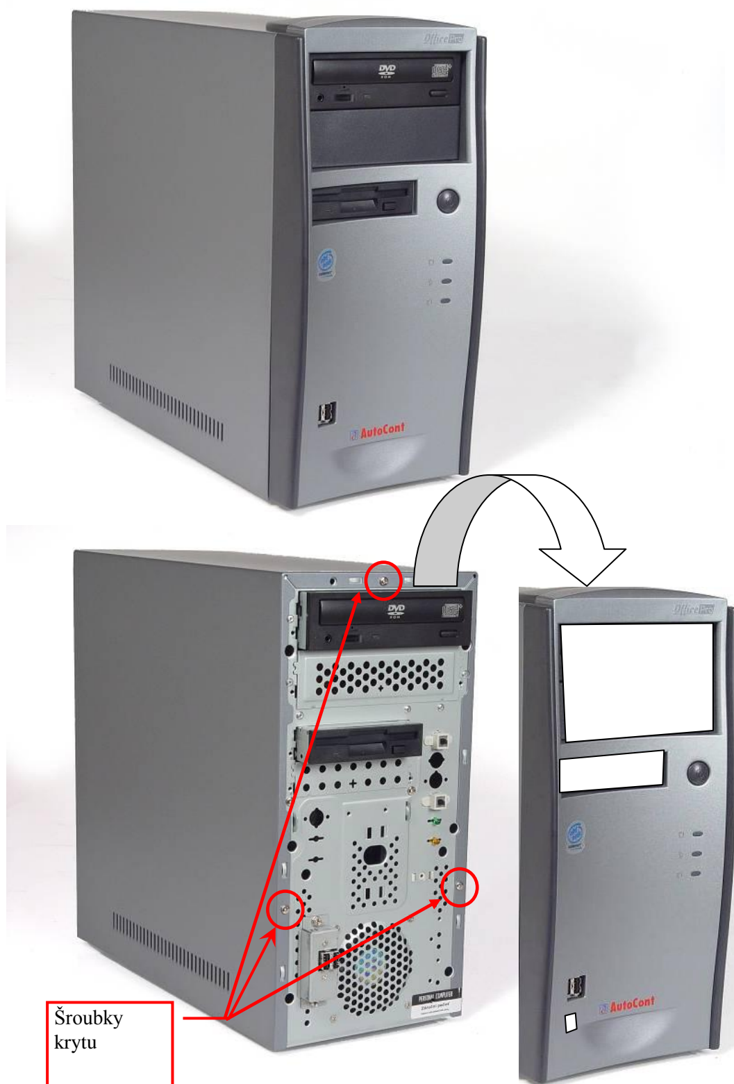
Obrázek 295 – demontáž krytu uchyceného zepředu
