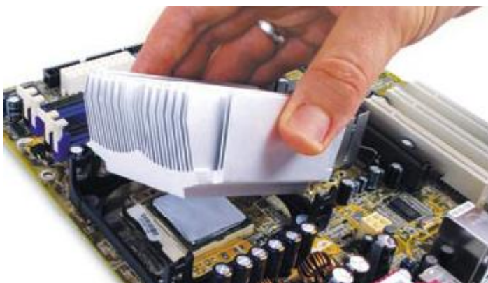
Obrázek 178 - Na natřený procesor opatrně nasadíte chladič, v našem případě vše ulehčuje plastový rámeček
