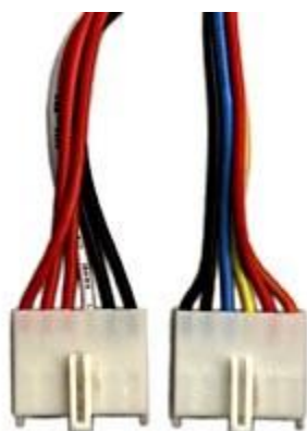
Obrázek 327 – konektory zdroje AT pro napájení základní desky
