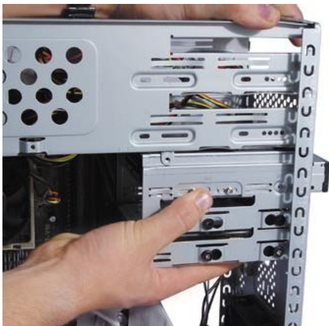
Obrázek 190 - Modul stačí zasunout do kolejniček a upevnit šroubem
