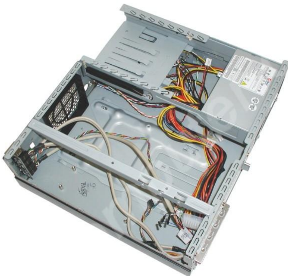
Obrázek 308 – vnitřní uspořádání desktopu Mikro BTX
