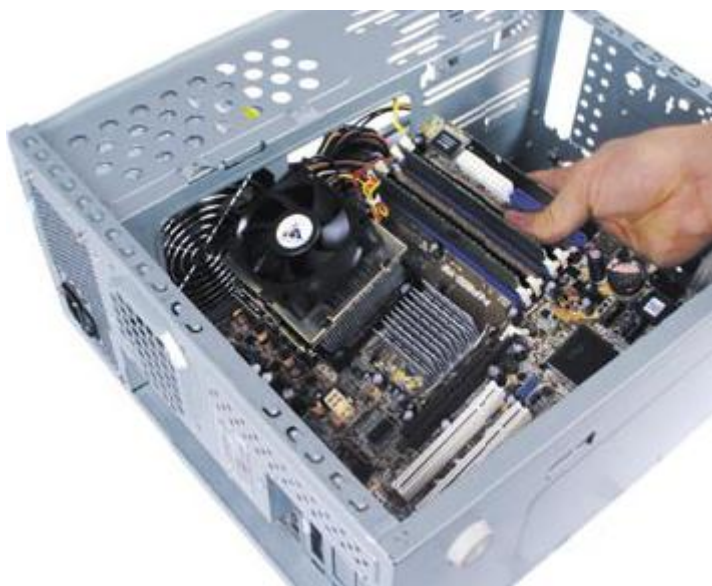
Obrázek 184 - Desku umístěte do skříně až po osazení procesoru a paměti
