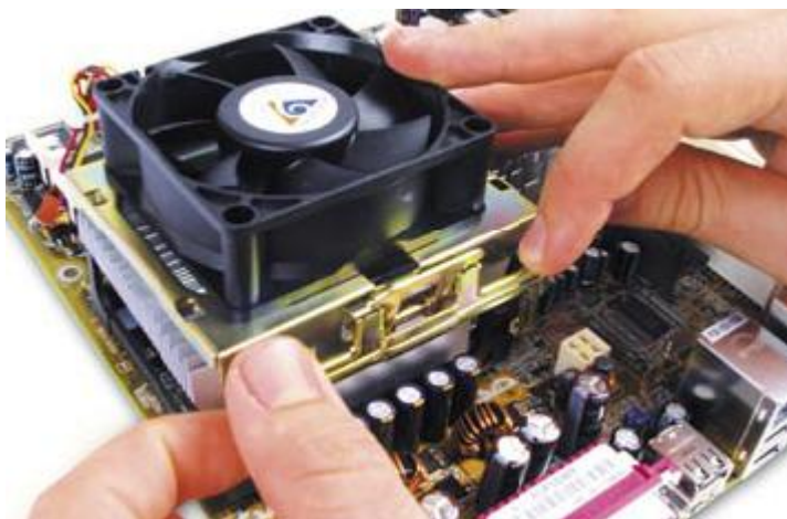
Obrázek 179 - Háčky ve spodní části spony zachytíte do připravených míst na umělohmotném rámečku základní desky a horní část spony zaklapnete, čímž zajistíte chladič v jeho pozici
