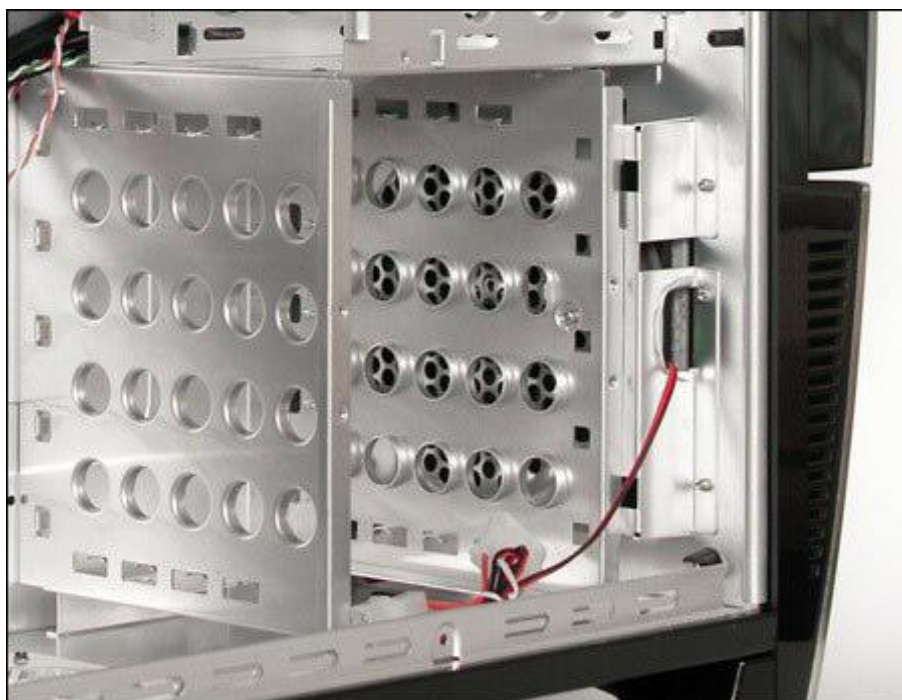
Obrázek 322 – nevhodně umístěná šachetice bránící proudění vzduchu z ventilátoru
