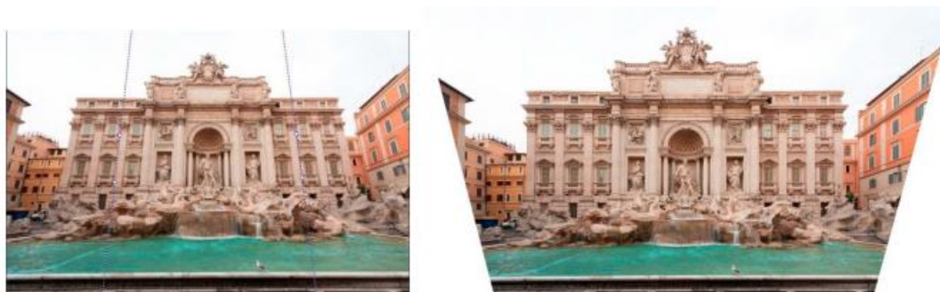
Obrázek 21: Ukázka kácení svislice před a po úpravě.
