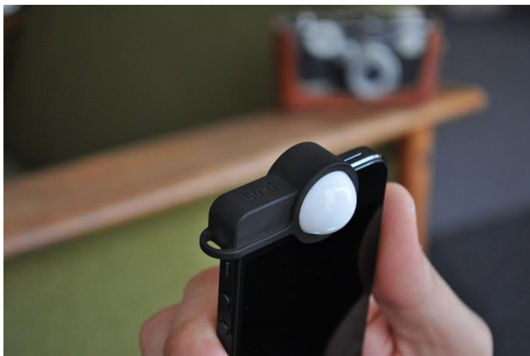
Obrázek 1-14: Kalota jako nástavec na mobilní telefon umožňuje spolu s vhodnou aplikací využít světlocitlivou buňku na mobilním telefonu jako expozimetru měřící dopadající světlo.
