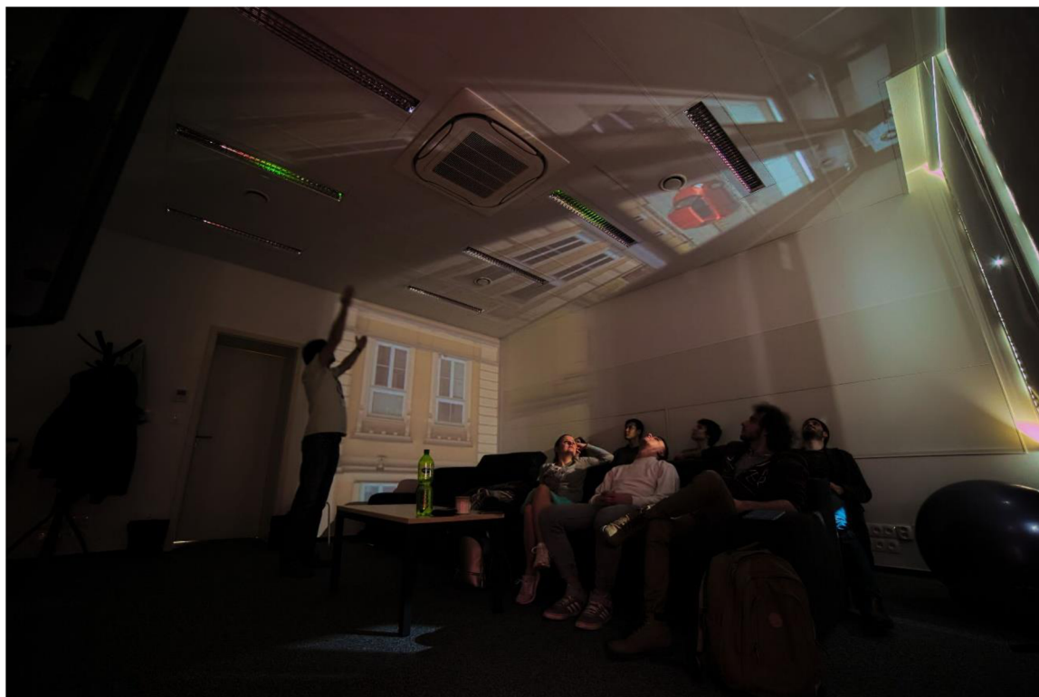
Obrázek 4-2: Camera obscura vytvořená na Slezské univerzitě v Opavě na oboru Multimediální techniky pomocí dírky o velikosti 1 \text{ cm}^2 v zatemňovací roletě.
