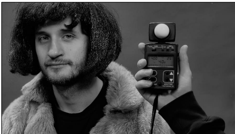
Obrázok 35: dopadajúce svetlo na objekt meriame luxmetrom. Meriame ním správnu svetelnú hladinu na scéne a zväčša hodnotu clony z luxmetru nastavujeme na kamere
