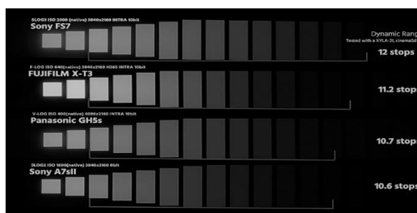
Obrázok 31: dynamický rozsah pre rôzne typy kamier a rôzne bit. hĺbky
