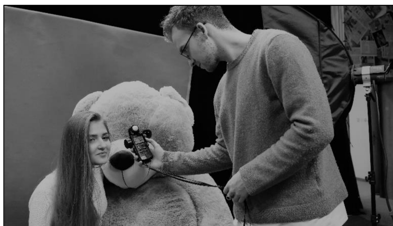
Obrázok 46: meranie dopadajúceho svetla luxmetrom, je potreba dať pozor na zatienie prístroja vlastným telom
