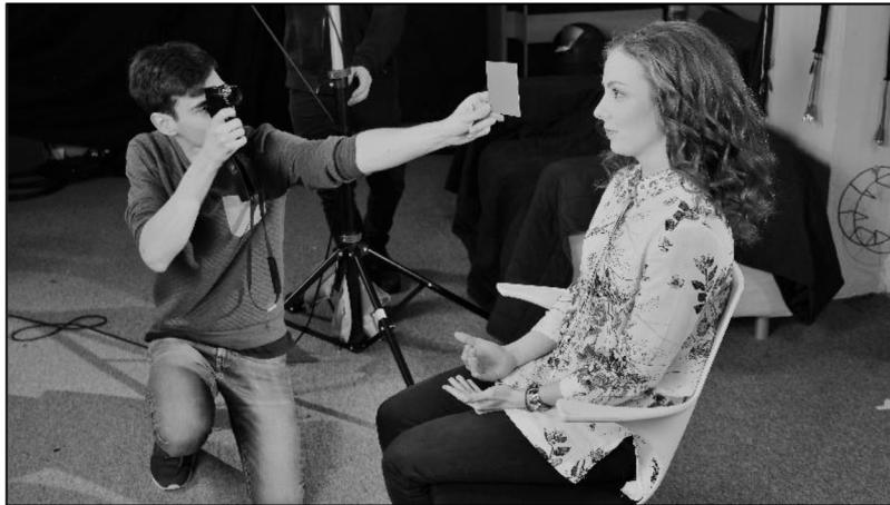
Obrázok 45: meranie spotmetrom pomocou šedej tabuľky
