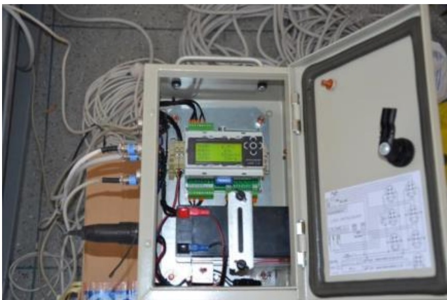
Obr. 3.5 Datalogger UJED pro záznam naměřených dat.
