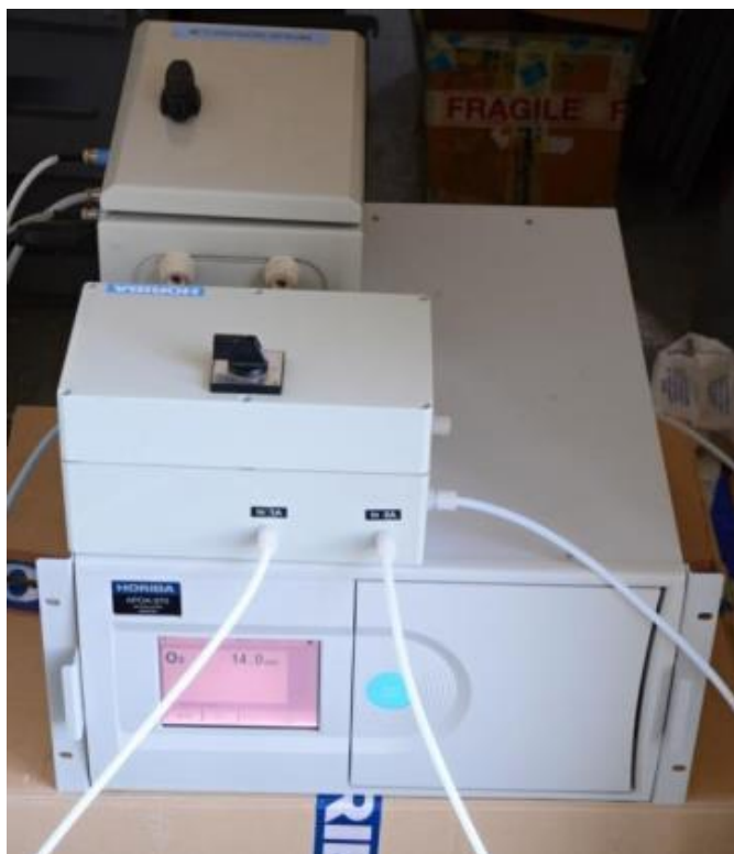
Obr. 3.2. Analyzátor APOA-370 a rozdělovač toků plynů.
