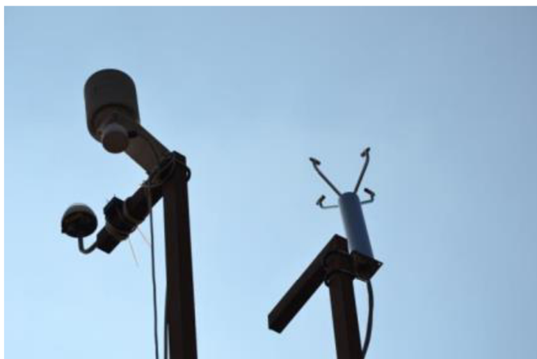
Obr. 3.4 Pyranometr RS 81 ENVITECH na měření intenzity slunečního záření, senzor teploty a vlhkosti vzduchu YOUNG a 2D ultrasonický anemometr GILL.
