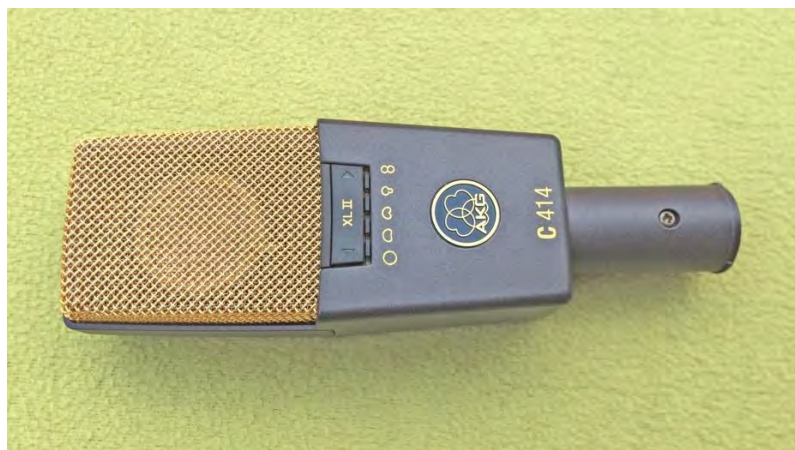
Obrázek 104 Mikrofon se dvěma mikrofonními vložkami s přepínatelnou směrovostí
