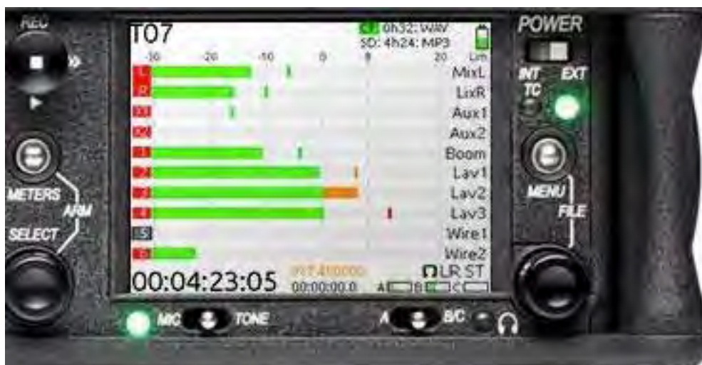
Obrázek 131 Displej digitálního vícekanálového metru vstupních úrovní digitálního profesionálního rekordéru
