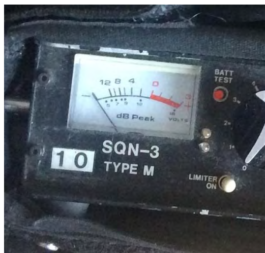
Obrázek 130 Analogový VU metr mobilního analogového zvukového mixeru
