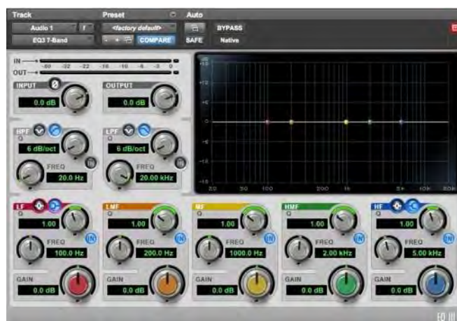
Obrázek 31 Software Plug-in EQ (ekvalizér) v základním nastavení bez vlivu na průchozí signál
