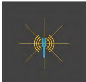
Obrázek 48 Zdroj periodického signálu – kulová vlnoplocha v otevřeném prostoru
