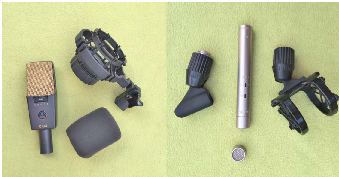
Obrázek 99 Kondenzátorové mikrofony s příslušenstvím (velká a malá membrána)
