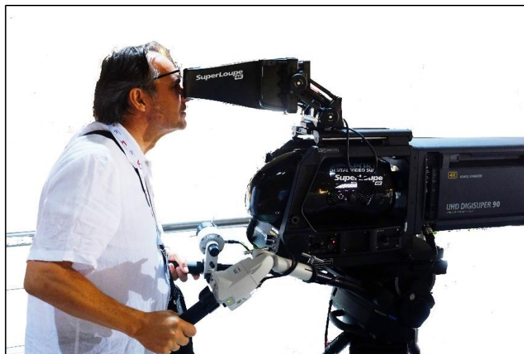
Obrázok 24: profesionálna kamera na televízne prenosy, pozorovací monitor má tienenie do exteriéru
