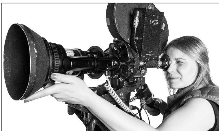
Obrázok 4: správna poloha kameramana vyžaduje cvik. V tomto prípade sa ľavá ruka ako obslužná, ľahko dotýka objektívu, ktorý kameraman zaostruje. Vodiaca ruka drží "švenkpáku" a vedie kameru.
