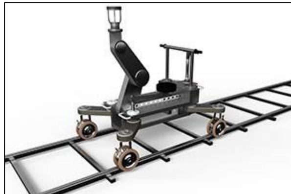
Obrázok 15: statív na vozíku s bantamovými kolieskami. Používa sa na koľajniciach a aj bez nich. Je to výhodné pre efektivitu práce pri zmene postavenia kamery vo všetkých smeroch. Toto zariadenie vyžaduje odborný personál
