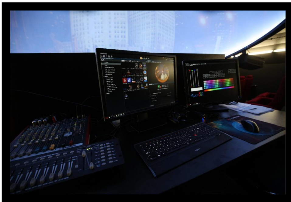
Obrázek 12: Pohled na řídicí pult Unisféry. Na monitorech je vidět vlevo prostředí Digistar 6 a vpravo ovládání osvětlení projekční kopule. 12
