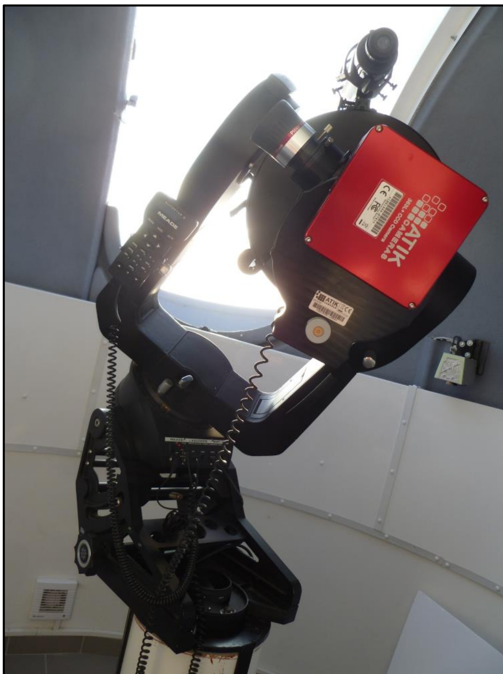
Obrázek 27: Dalekohled při vizuálním pozorování Slunce. Pohled je na celou sestavu dalekohledu, včetně pilíře, vidlicové montáže na klínu a samotného dalekohledu s okulárovým výtahem a příslušenstvím.
