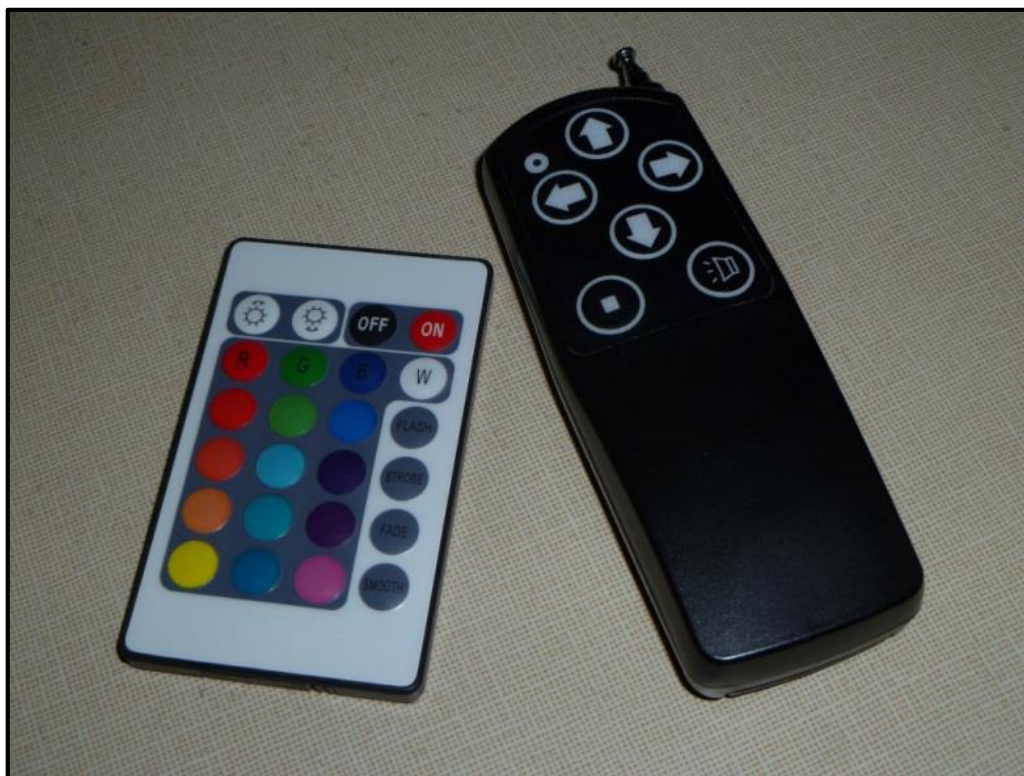
Obrázek 6: Dálkové ovládání osvětlení kopule, dálkové ovládání otevírání a zavírání štěrbin kopule a otáčení kopule.
