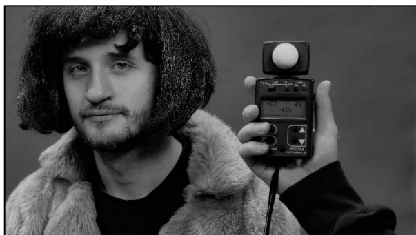
Obrázok 42: dopadajúce svetlo na objekt meriame luxmetrom. Meriame ním správnu svetelnú hladinu na scéne a zväčša hodnotu clony z luxmetru nastavujeme na kamere
