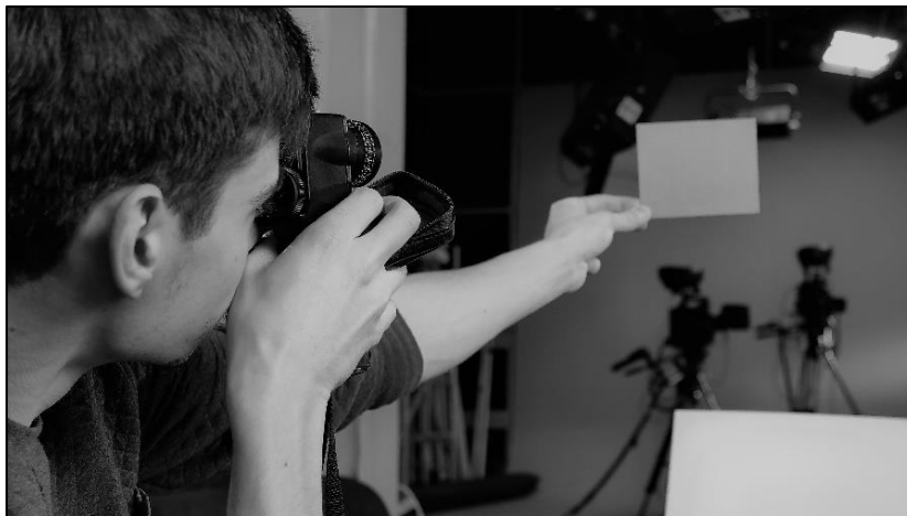
Obrázok 40: spotmeter využívame na meranie osvetlenia referenčnej plochy v presne vymedzenom uhle a smere. Vieme ním merať napríklad svetelný pomer na scéne.
